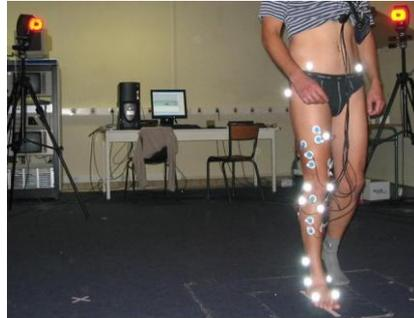
Figure 3.9: Enregistrement d'un mouvement de marche avec un système dernière génération MOTION ANALYSIS.
