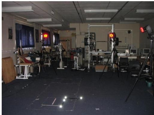
**Figure 3.7: Objet de calibrage permettant de déterminer les paramètres de la matrice de projection de chaque caméra et d'attribuer un référentiel fixe  $R_0 = (OX_0Y_0Z_0)$  dans lequel les coordonnées des marqueurs sont exprimées**
