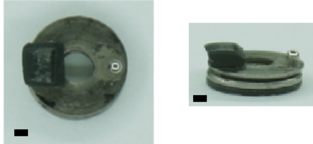
FIGURE 2.9 – Particule autopropulsée 5 de diamètre 7,1 mm. Les lignes noires représentent une longueur de 1 mm. Gauche Vue de la partie inférieure de la particule. Droite Vue de côté de la particule.
