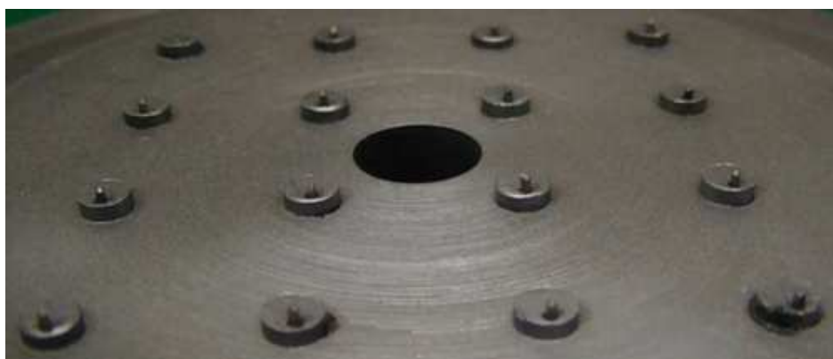
FIGURE 2.17 – Plaque de fixation de l'axe de la polarité de 16 SPP. Plaque de 16 tiges métalliques de longueur 0.75 mm et de diamètre 0.7 mm.
