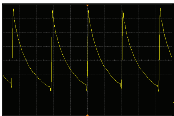
FIGURE 3.9 – Oscillogramme de tension correspondant au montage de la figure 3.8 avec U_{DC} = 15 \text{ kV} C_{reacteur} = 100 \text{ pF} et R_0 = 100 \text{ M}\Omega - \Delta x = 50 \text{ ms/div} ; \Delta y = 2 \text{ kV/div}
