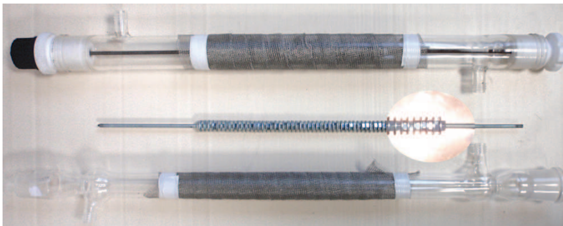
FIGURE 3.19 – Réacteurs disque-cylindre et Liebig (2 diélectriques)
