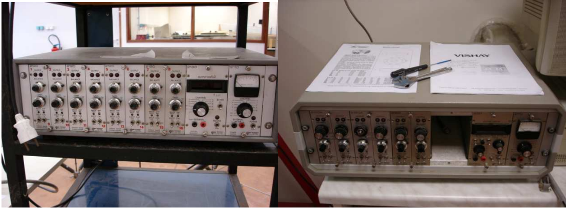
Figure 50. Conditionneurs Vishay utilisés pour les mesures d'efforts.
