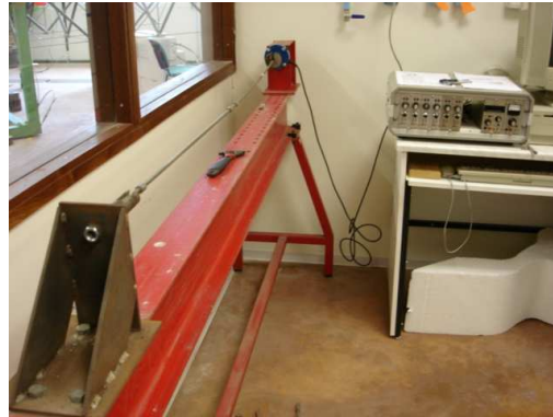
Figure 47. Banc de tension pour l'étalonnage des tirants.
