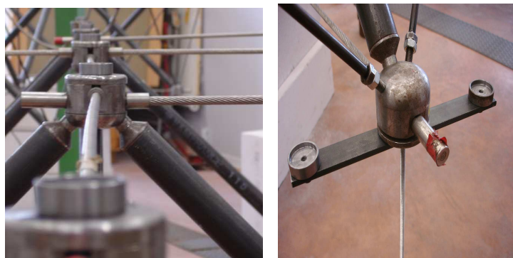
Figure 54. Aménagements pour le positionnement des cibles sur les nœuds.
