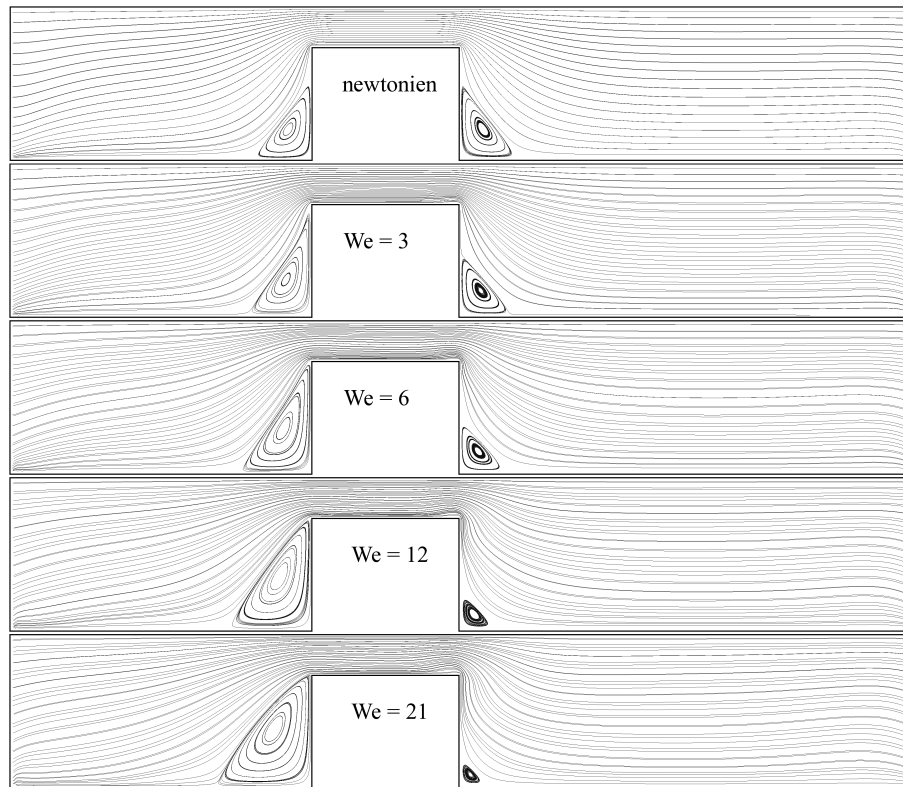
FIG. 7.21 – Contraction 4:1:4 : lignes de courant pour le modèle de Giesekus
