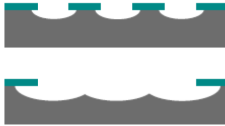
Figure II. 2: Phénomène de sous-gravure lors de la gravure humide isotrope.
