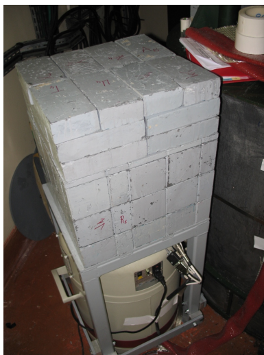
FIGURE 4.13: Mise en place du château de plomb sur la diode HPGe.
