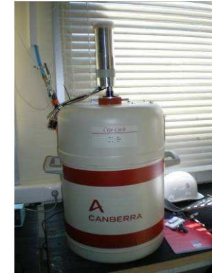
Diode HPGe montée sur un Cryostat hybride Cryo-Cycle
