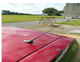
FIGURE 4.25 – Antenne fouet FM au dessus du toit de la ( C2 )
