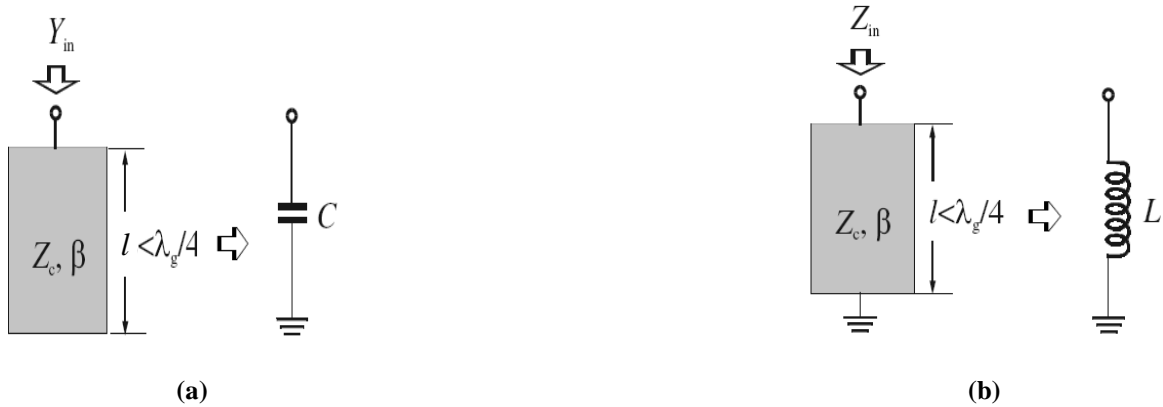
Figure III. 6 : Modèle électrique équivalent d'un: (a) stub ouvert. (b) stub en court circuit. [d'après III.4]
