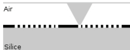
Fig. 3.22 – Coupe verticale de la cavité CL7 et de la pointe située à une extrémité de la cavité.
