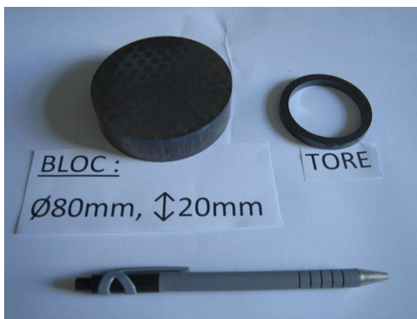
FIGURE 5.34: Photographie du bloc de matériau « Prototyping » acheté auprès de la société Höganäs, et d'un tore découpé dans un tel bloc
