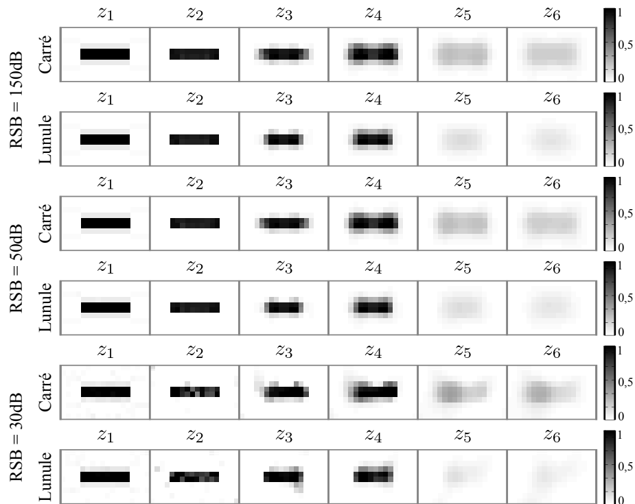
FIGURE 4.19 – Sources estimées dans le cas 2 et pour trois niveaux de RSB, après inversion du système par descente de Newton et régularisation par variation totale en contraignant la valeur des sources.
