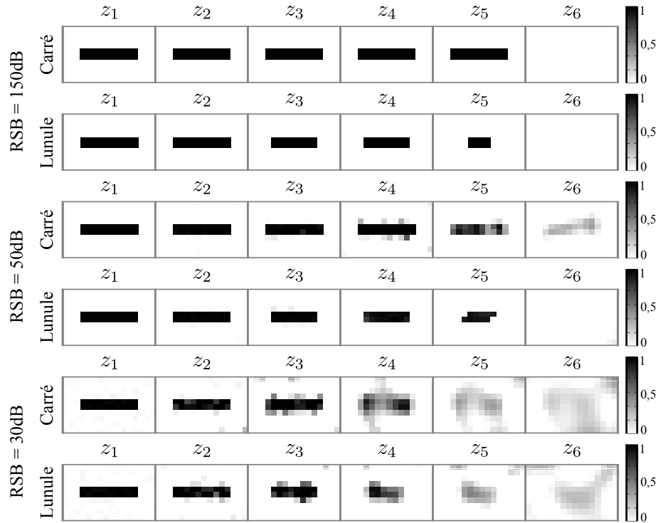
FIGURE 4.16 – Sources estimées dans le cas 1, après inversion du système par descente de Newton et régularisation de la norme L2 avec contrainte sur la valeur des sources, pour trois valeurs de RSB.
