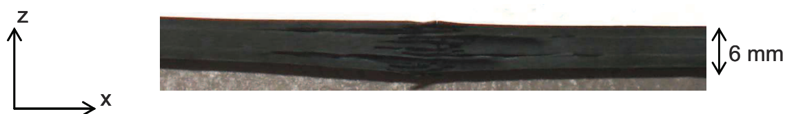
Figure 4.20 : Photo d'une éprouvette "représentative" des conditions de service du réservoir après rupture en traction quasistatique.
