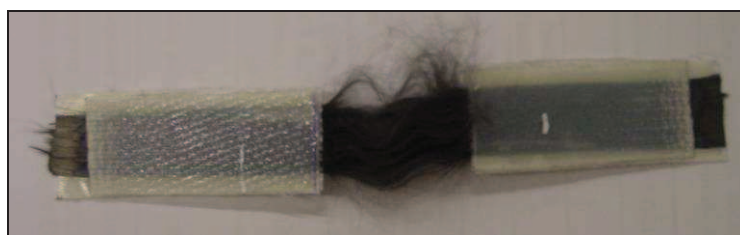
Figure 3.9 : Ruban de fibres de carbone rompu.
