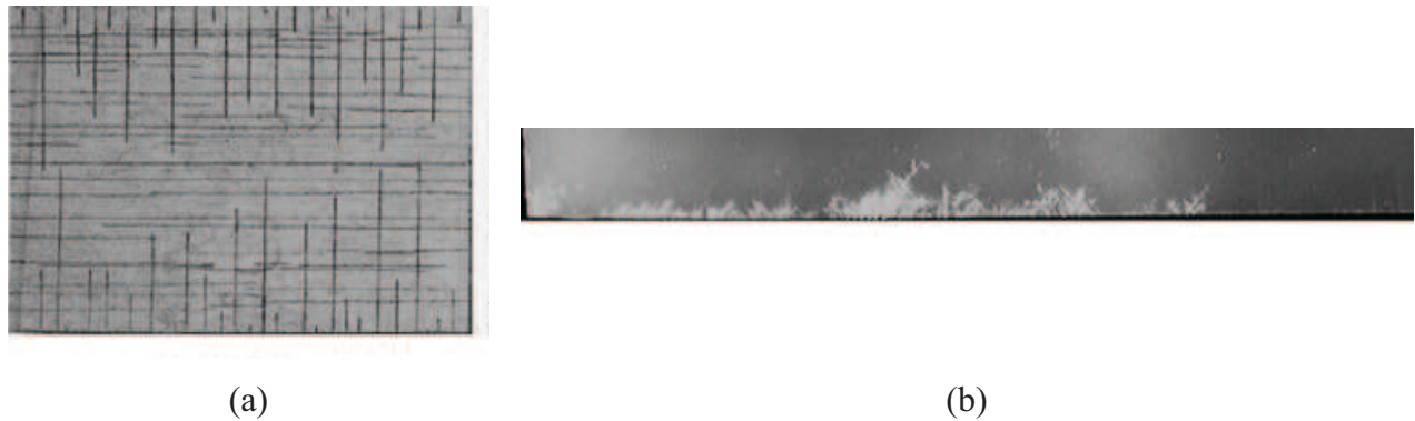
Figure 1.8 : Radiographies X de stratifiés composites : (a) fissures matricielles [ROU05] et (b) fissures matricielles et délaminages [HU10].
