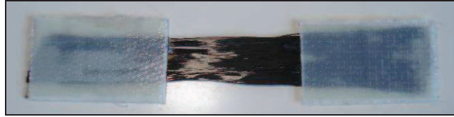
Figure 3.4 : Ruban de fibres de carbone muni de talon en composite à fibres de verre.
