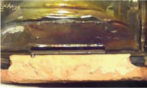
I=1600A . Le liquide est refoulé dans le creuset
