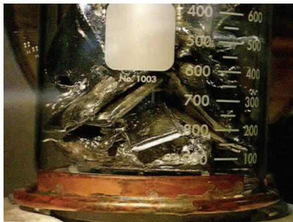
Figure 4-5 : Inducteur à plaque verticale.
