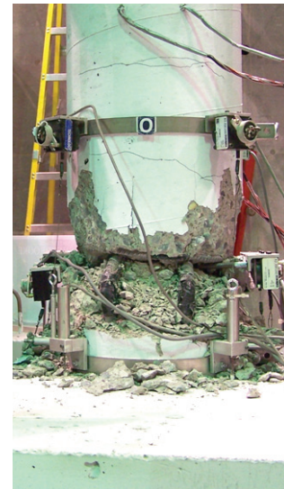
Sans TFC – Charge axiale 35% - Espacement des cadres 150mm.
