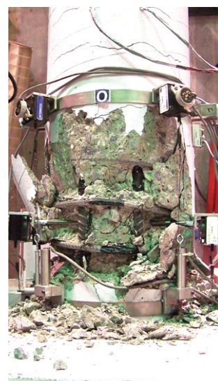
Sans TFC – Charge axiale 35% - Espacement des cadres 75mm.
