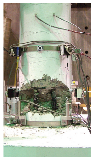
Sans TFC – Charge axiale 10% - Espacement des cadres 150mm.
