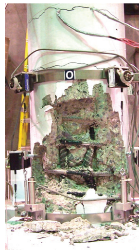
Sans TFC - Charge axiale 10% - Espacement des cadres 75mm.
