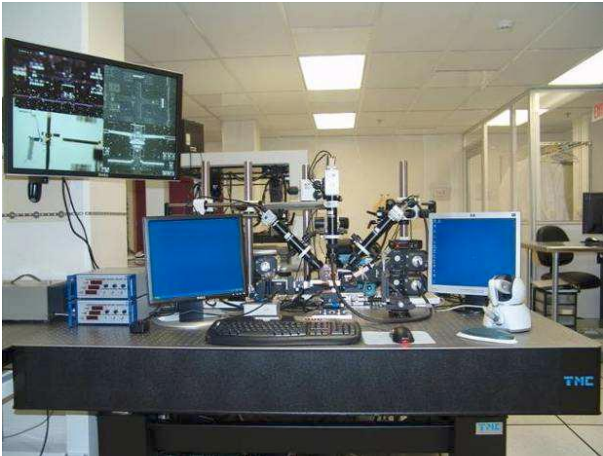
2.61 – Micro-usine “ \mu 3 ” de micro-assemblage, à ARRI’s Texas [ Pop09 ] et son IHM haptique
