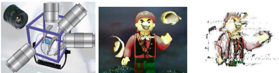
2.39 - Principe d'une construction de vue virtuelle par transfert trifocal
