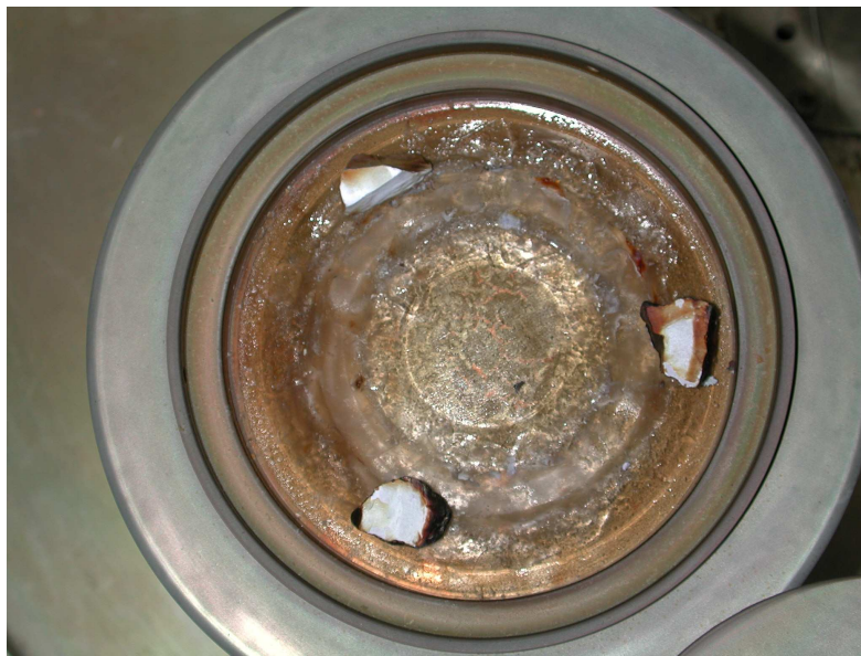
Figure IV.1 : Photographie de la cible de silice avec trois morceaux de Nd 2 O 3 .
