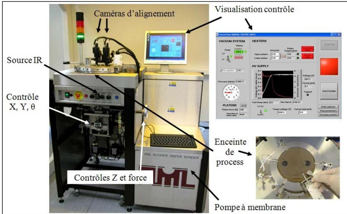
Fig III. 17. Photo de l'appareil d'assemblage AML[31]
