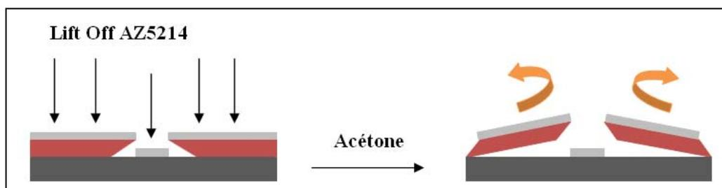
Fig III. 5. Réalisation des lignes par lift-off
