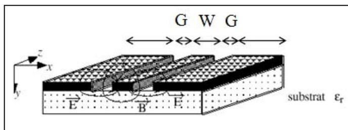
**Fig II. 12. Calcul des dimensions pour la ligne coplanaire**
