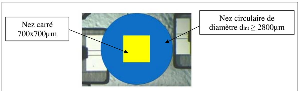
**Fig III. 37. Dimensions et configuration des nez de mesure**
