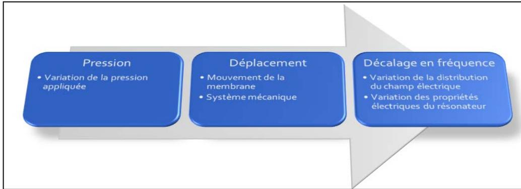
Fig II. 1. Schéma synoptique du capteur EM
