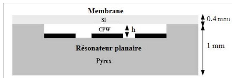
Fig II. 3. Vue en coupe de la cellule de mesure de la pression
