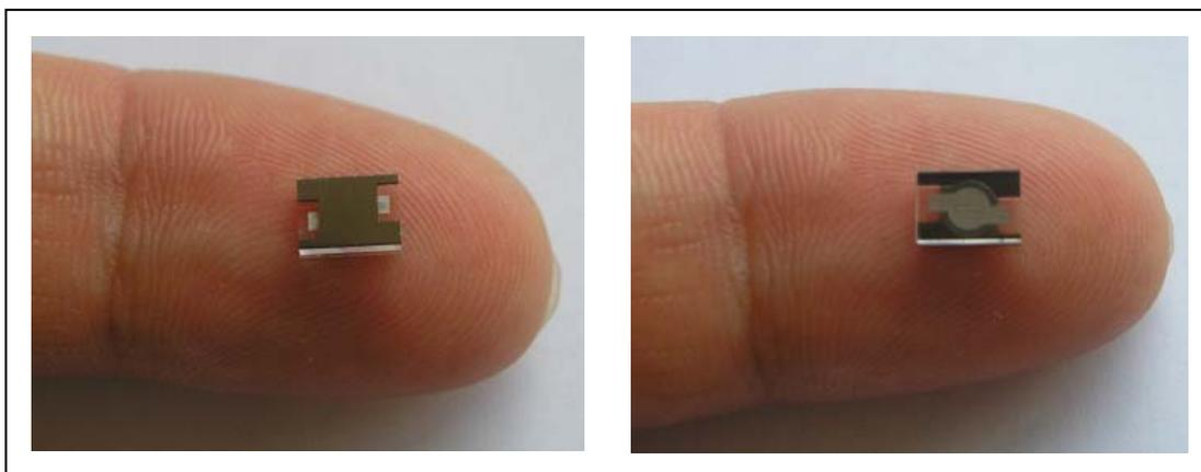
**Fig III. 19. Photos des premiers prototypes du capteur de pression à transduction électromagnétique**
