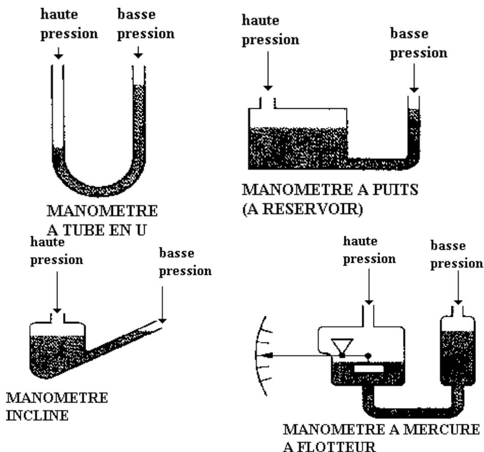
Fig A. 2. Différents types de manomètres
