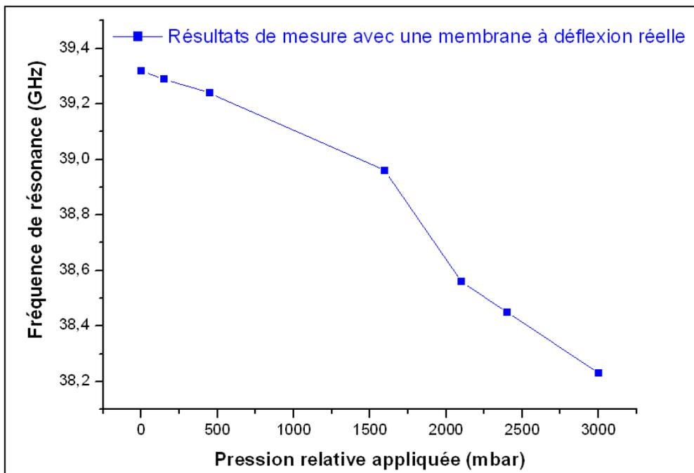
**Fig III. 38. Mesures de la variation de la fréquence de résonance en fonction de la pression**
