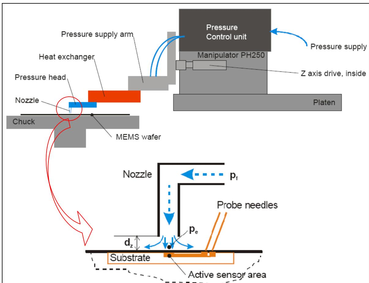
**Fig III. 25. Conception mécanique du module de pression**
