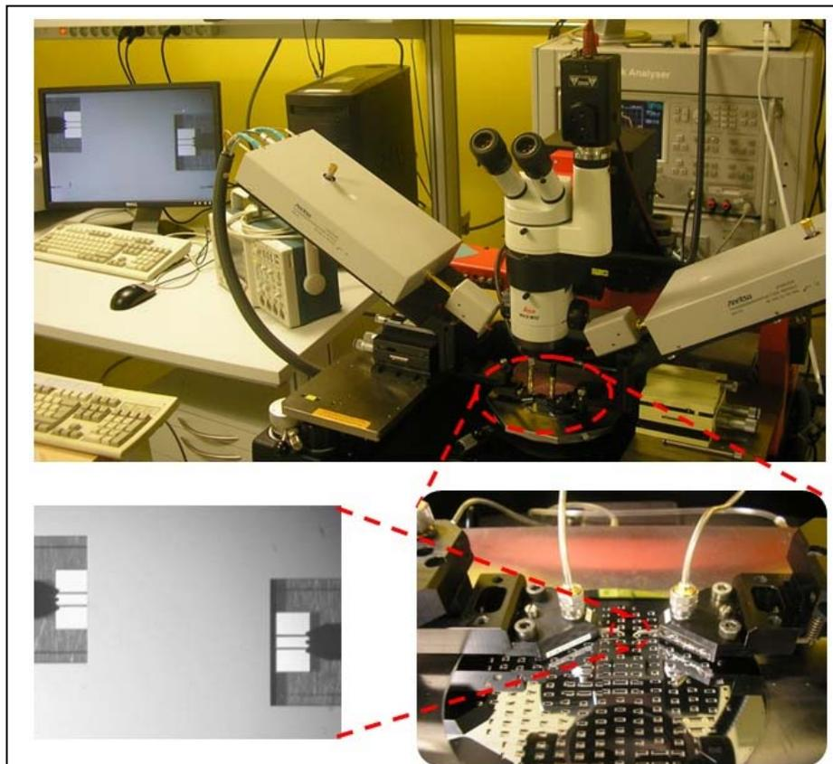
Fig III. 23. Dispositif de mesure sur wafer
