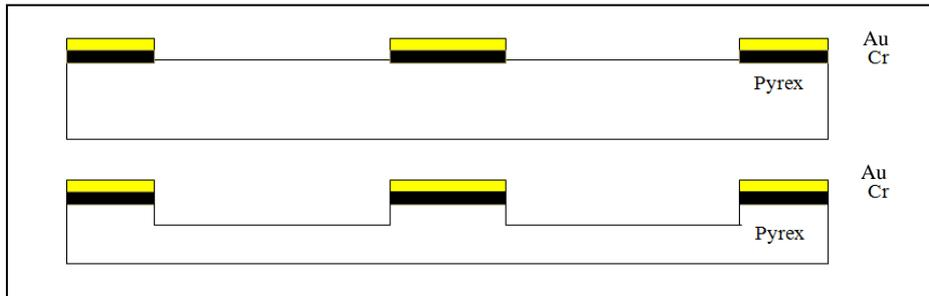
Fig III. 4. Réalisation de la cavité
