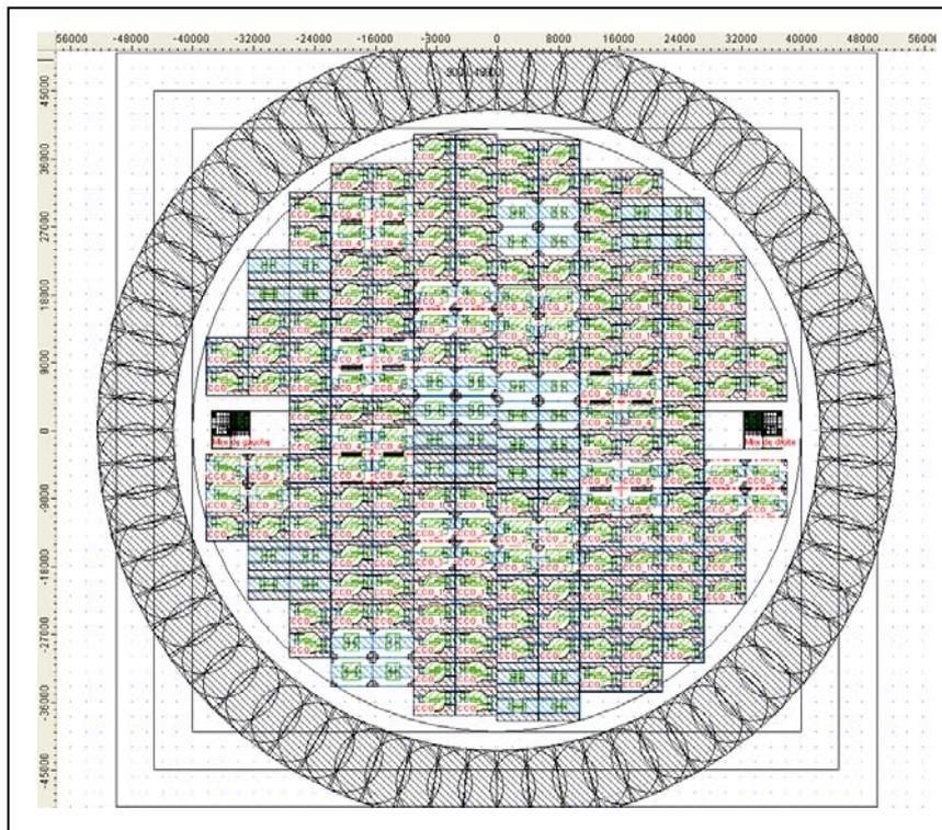
Fig III. 2. Masques de la plaquette à réaliser
