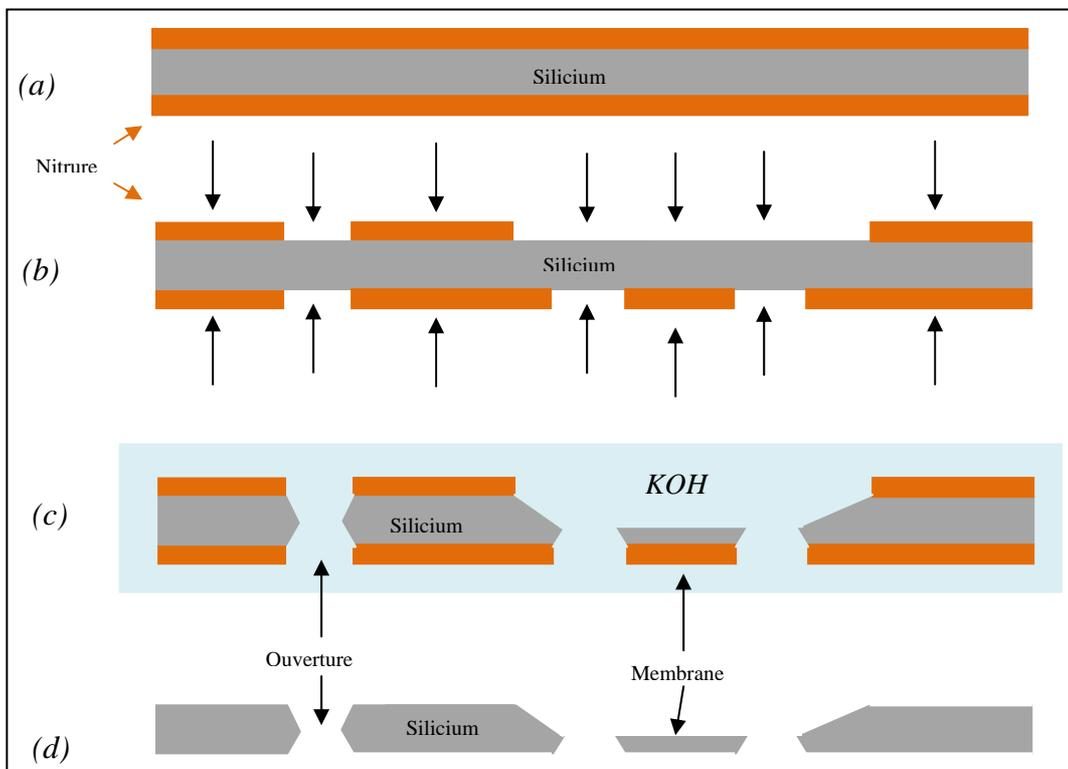
Fig III. 21. Procédé de fabrication des membranes pour les capteurs de pression à transduction électromagnétique (vue en coupe)
