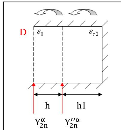
Fig II. 6. Admittance ramenée au plan de discontinuité
