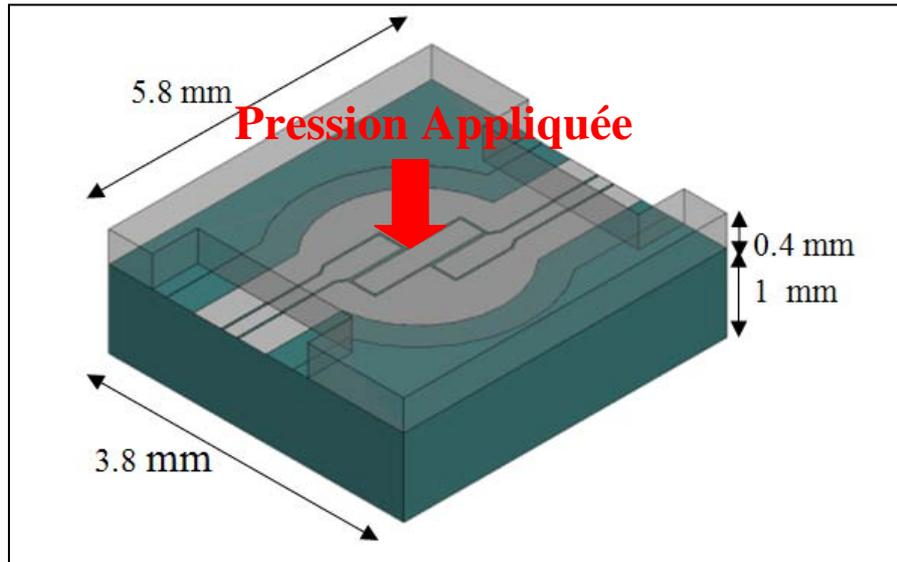
Fig II. 14. Premier prototype du capteur à transduction EM
