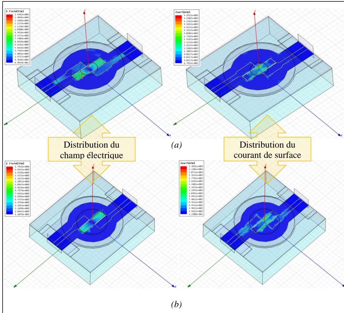
**Fig II. 27. Distribution du champ électrique et du courant surfacique à la résonance pour deux capteurs avec une déflexion de membrane de  $4\mu\text{m}$  et des diamètres de : (a)  $700\mu\text{m}$  et (b)  $1400\mu\text{m}$**
