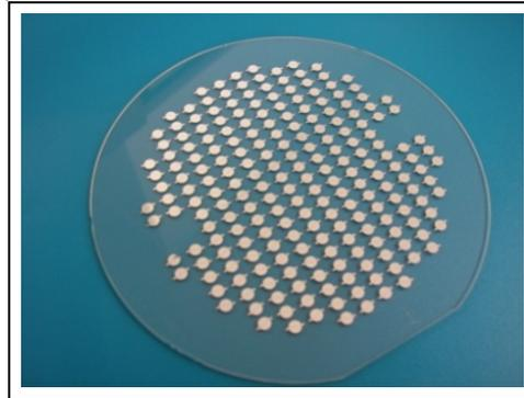
Fig III. 10. Plaque de Pyrex avec des circuits résonants déposés dans des cavités gravées
