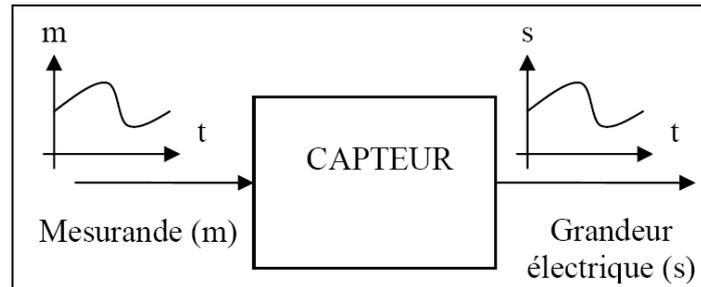
**Fig I. 1. Schéma synoptique d'un capteur [13]**
