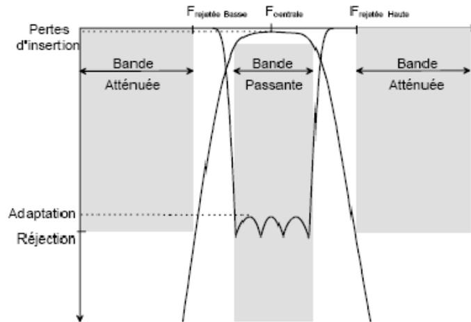
**Fig E. 1. Gabarit et réponse électrique d'un filtre passe-bande**
