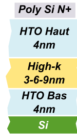
FIG. 3.11: Structure capacitive tricouche étudiée.
