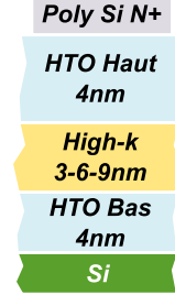
FIG. 3.24: Structure capacitive tricouche étudiée.
