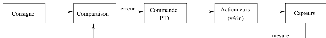
FIG. 2.9: Régulation PID par boucle fermée.
