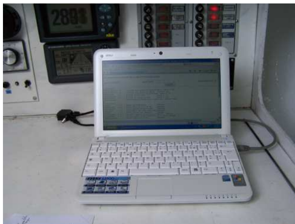
Le PC communique via un câble Internet avec le processorHR et peut prendre éventuellement la main pour commander le pilote.
