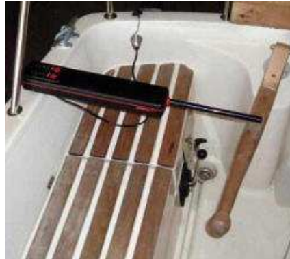
Un pilote de cockpit intègre dans un même boîtier le vérin, l'électronique et le clavier. Fixé sur le côté du cockpit, il n'est pas débrayable et nécessite un réglage de course avant de pouvoir être solidariser à la barre.
