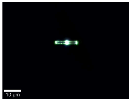
FIGURE 3.1 – Observation en microscope confocal de la photoluminescence d'un nanofil unique de GaN MOCVD couché sur une grille pour TEM et pompé par un faisceau laser ( \lambda = 407nm ).
