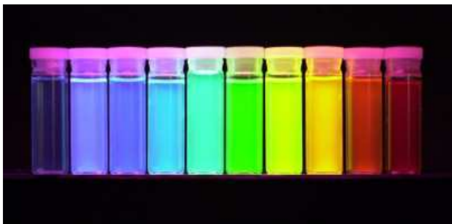
FIG. 2.11: Fluorescence d'une série de Quantum Dots de taille croissante (de gauche à droite). La longueur d'onde d'émission varie de 500 nm à 800 nm. Reproduit de (Qi 2008)
