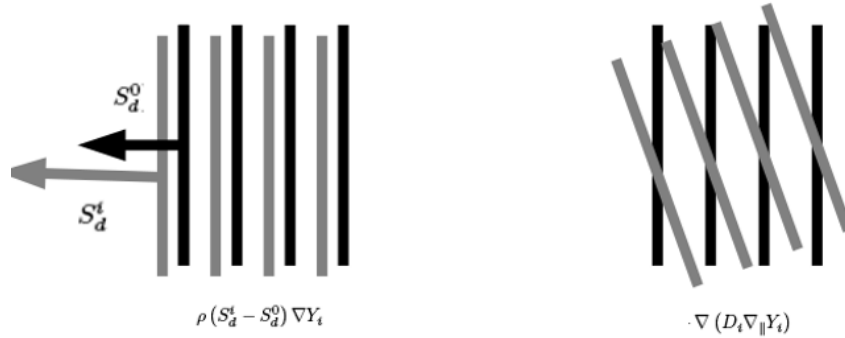
FIG. 2.12 – Effets des différentes contributions du terme \mathcal{Q}_i sur les iso-surfaces de c (en noir) et des Y_i (en gris) à travers une flamme de prémélange laminaire [155].
