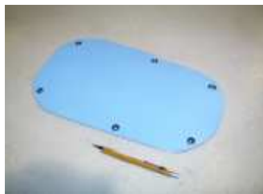
Fig. 1.16 – Trappe d'accès en carbone/époxy [CHE08]
