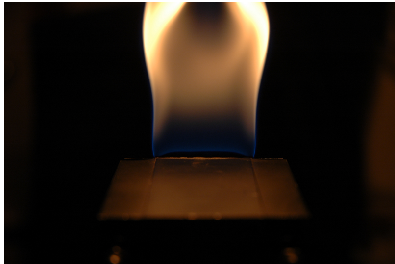
Fig. 6.15 – Photographie d'une flamme non-prémélangée Propane-Air stabilisée sur notre brûleur plan 2D, avec la lèvre épaisse "A". On peut distinguer la région de proche sillage où le prémélange isotherme en amont du front de flamme se forme (à quelques millimètres, dans la zone de Rott-Hakkinen).
