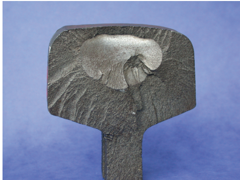
(a) Rupture simple sur rail
