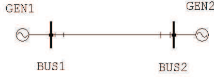
Fig. 4.4. Exemple deux machines
