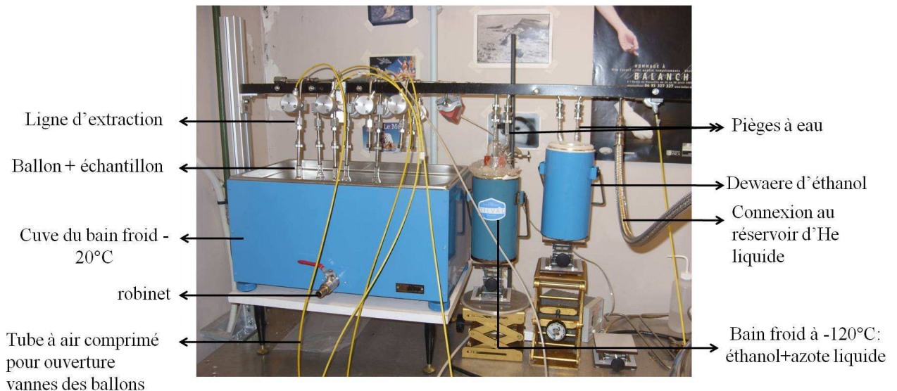
Figure 1 : Montage expérimental de l'extraction des gaz pour l'analyse du \delta^{18}\text{O}_{\text{atm}} et du \delta^{15}\text{N} de \text{N}_2 au LSCE
