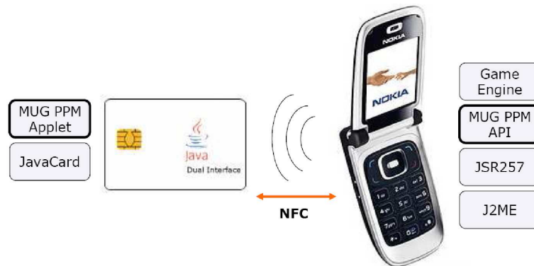
FIG. 6.2 – Architecture du système de gestion de PJJMU pour les téléphones J2ME
