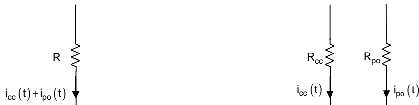
Figure 2.6 : Proposition de décomposition d'une fonction dont la consommation appartient au système de contrôle-commande et à la partie opérative en deux fonctions virtuelles disjointes.
