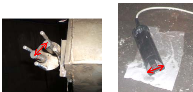
Figure 21 : faisceau optique de mesure entre les cellules optiques (à gauche, turbidimètre de marque Mobrey (Site de Maxeville à Nancy), à droite turbidimètre de marque Ponsel (Site de Clichy à Paris))
