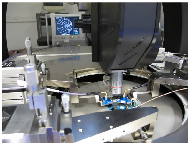
Figure 0-4 : Station sous pointes et analyseur de réseau vectoriel pendant une mesure à hautes fréquences (40 MHz à 40 GHz) sur un échantillon intégrant du TiTaO en structure MIM.
