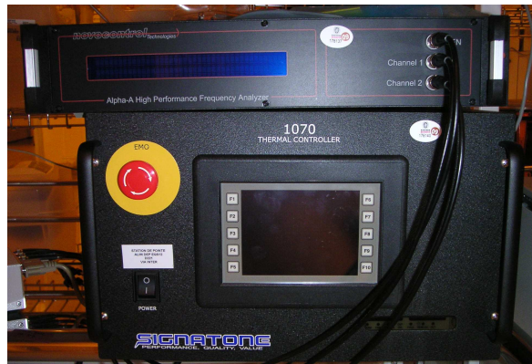
Figure 3-2 : Spectromètre diélectrique couplé à un module chauffant pour la caractérisation en basses fréquences (de 10^{-3} Hz à 10^{+6} Hz).
