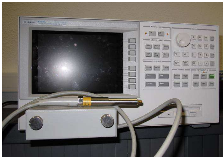
Figure 3-6 : Impédancemètre Agilent 4294A pour les mesures en moyennes fréquences avec la tête d'adaptation pour la connexion de la sonde.
