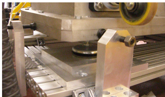
Fig. 2.14 – Photographie du système de translation du spectromètre.
