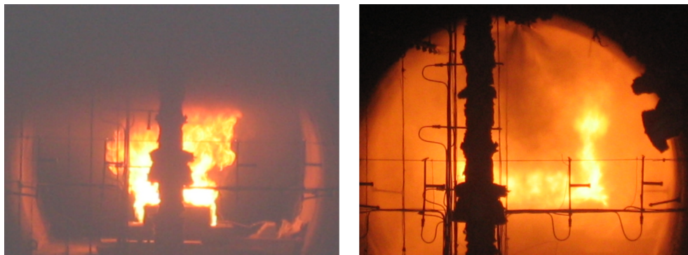
FIG. V.21 – Visualisation du foyer depuis l'entrée, sans brouillard d'eau (à gauche) et avec brouillard d'eau (à droite)
