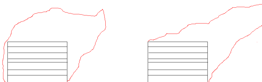
FIG. IV.57 – Variation de l'aspect de la flamme pour un feu de bûcher. Evolution de la géométrie globale de la flamme en fonction de la vitesse de ventilation
