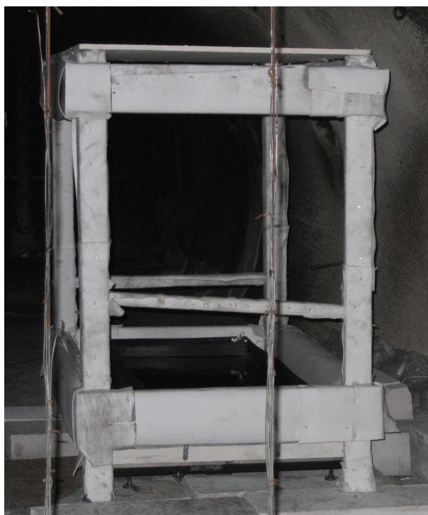
FIG. III.3 – Vue de la couverture du foyer heptane
