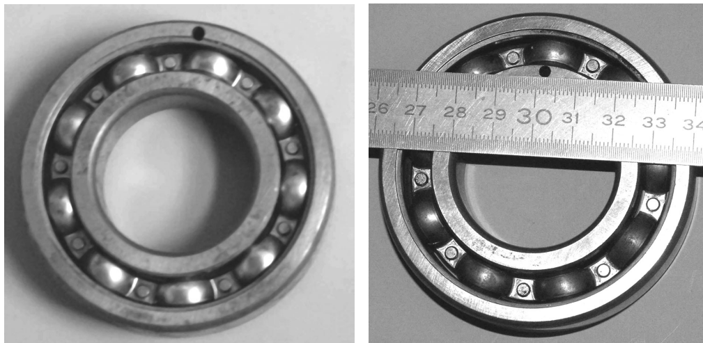
(a) Défaut localisé sur la bague externe
