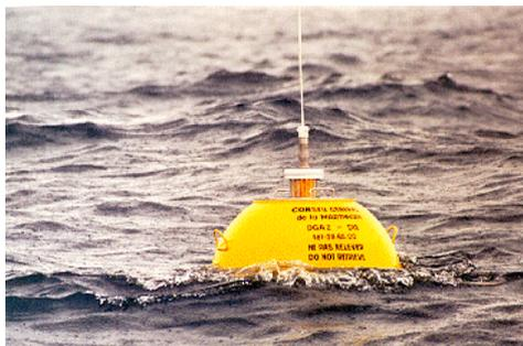
Figure III. 13 : Photographie d'une bouée datawell déployée [source DREAL LR].
