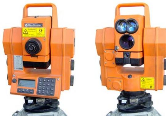
Figure III. 3 : Théodolite de type Geodimeter 400, utilisé lors du suivi topographique.
