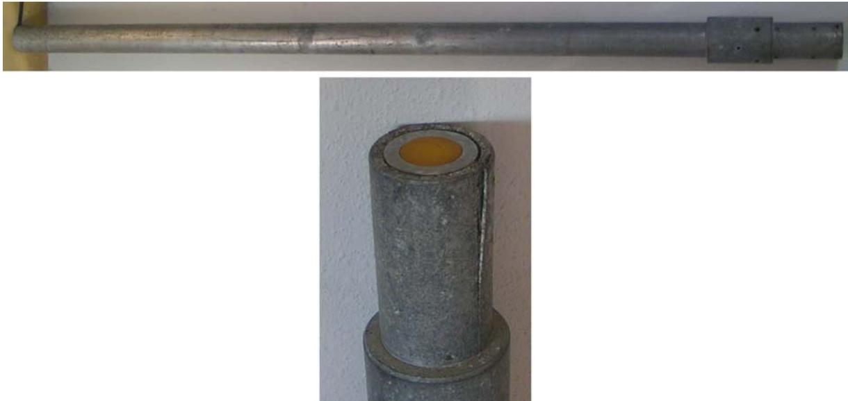
**Figure III. 2 : Photographie d'un sondeur mono-faisceau de type Tritech ST500.**
