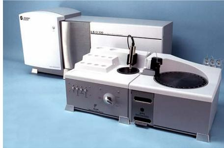
Figure III. 22 : Granulomètre laser Coulter LS13320 ayant servi lors des analyses granulométriques.
