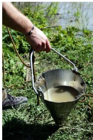
**Figure III. 21 : Photographie d'un cône Berthois, ayant servi lors des échantillonnages granulométriques de surface de l'avant-côte.**
