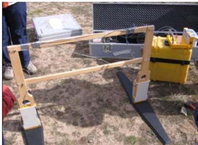
Figure III. 8 : Photographie du géoradar déployé [source Laboratoire Géosciences Montpellier].
