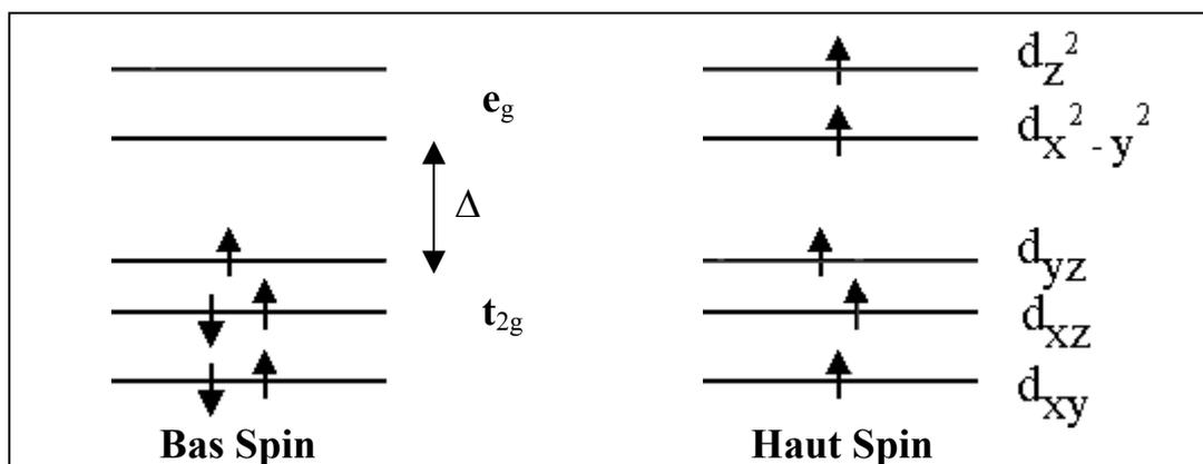
**Figure A.8.** Représentation de l'occupation des orbitales moléculaires 3d du fer au degré d'oxydation (+3) par ses 5 électrons, suivant les deux états de spin permis : bas spin (BS) et haut spin (HS).
