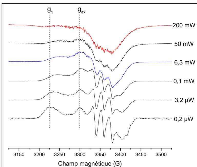
**Figure IV.13.** Etude en saturation de l'échantillon Fe<sup>II</sup>-NO de iNOSoxy +Arg/+H<sub>4</sub>B à 4 K. La puissance varie de 0,2 μW à 200 mW, tous les autres paramètres étant égaux. Les valeurs de g retenues pour suivre l'évolution de l'amplitude du signal en fonction de la puissance pour les formes dites rhombique (g<sub>1</sub>) et axiale (g<sub>ax</sub>) sont indiquées.
