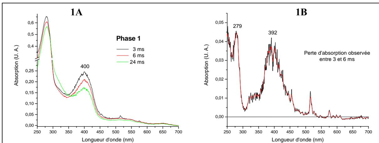
**1. Première phase de la réaction.** A) Superposition des spectres d'absorption enregistrés après 3, 6 et 24 ms de réaction. B) Spectre de différence obtenu par soustraction du spectre enregistré à 6 ms à celui enregistré à 3 ms; la différence positive d'absorption correspond à l'absorption perdue entre 3 et 6 ms de réaction.
