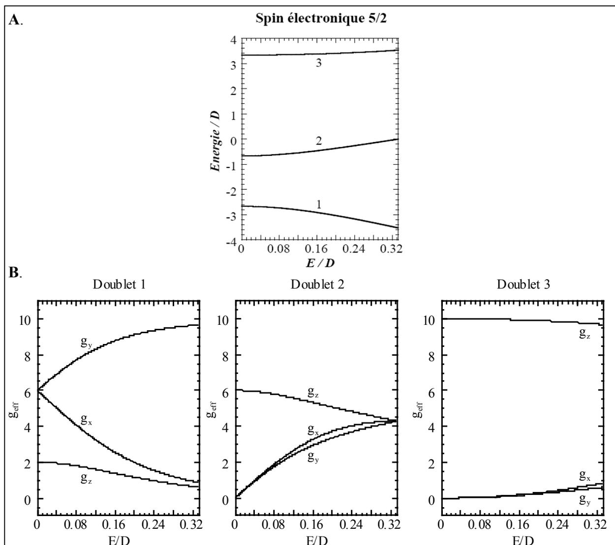
**Figure A.9.** A. Variation en énergie des trois doublets de Kramer d'un système de spin  $S=5/2$  en champ nul en fonction de la rombicité du ZFS (*Zero Field Splitting*). B. Détail de la séparation des valeurs de  $g$  des 3 doublets de Kramer.
