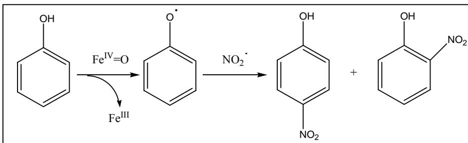
**Figure III.8.** Mécanisme de nitration de composés phénoliques par PN, catalysée par une métalloporphyrine à fer.
