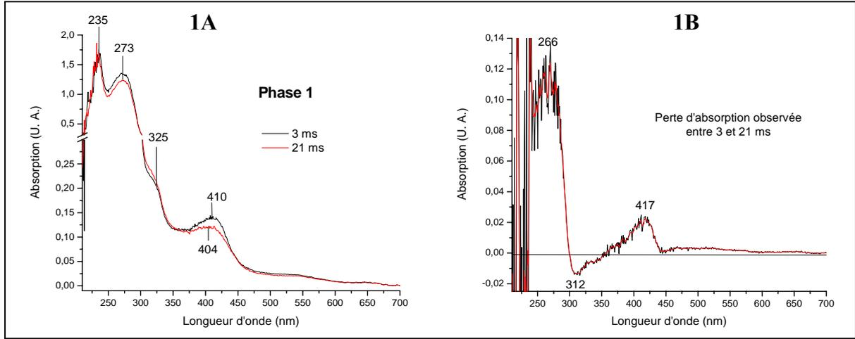
**1. Première phase de la réaction.** A) Superposition des spectres d'absorption enregistrés après 3 et 21 ms de réaction. B) Spectre de différence obtenu par soustraction du spectre enregistré à 21 ms à celui enregistré à 3 ms; la différence positive d'absorption correspond à l'absorption perdue entre 3 et 21 ms de réaction.
