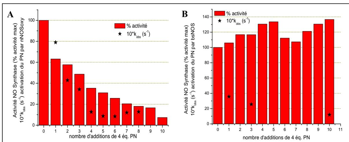
**Figure III.58.** Effet d'activations successives de PN par nNOSoxy (A) et bsNOS (B) sur leurs propriétés enzymatiques. Histogrammes: inhibition de l'activité NO synthase de nNOSoxy et bsNOS après activation de  $n \times 4$  éq. PN. Etoiles: inhibition de la capacité de nNOSoxy et bsNOS à activer la décomposition du PN après activation de  $n \times 4$  éq. PN.
