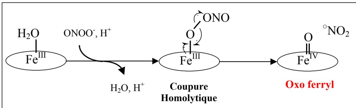
**Figure III.21.** Mécanisme proposé pour l'activation du peroxyinitrite par l'isoforme inductible de NOS. La première étape correspondrait à la fixation du peroxyinitrite avec déplacement de la molécule d'eau. La seconde étape consisterait en la rupture homolytique de la liaison O-O du PN, catalysée par le fer, pour former une paire oxoferryl - radical  $\cdot\text{NO}_2$ .
