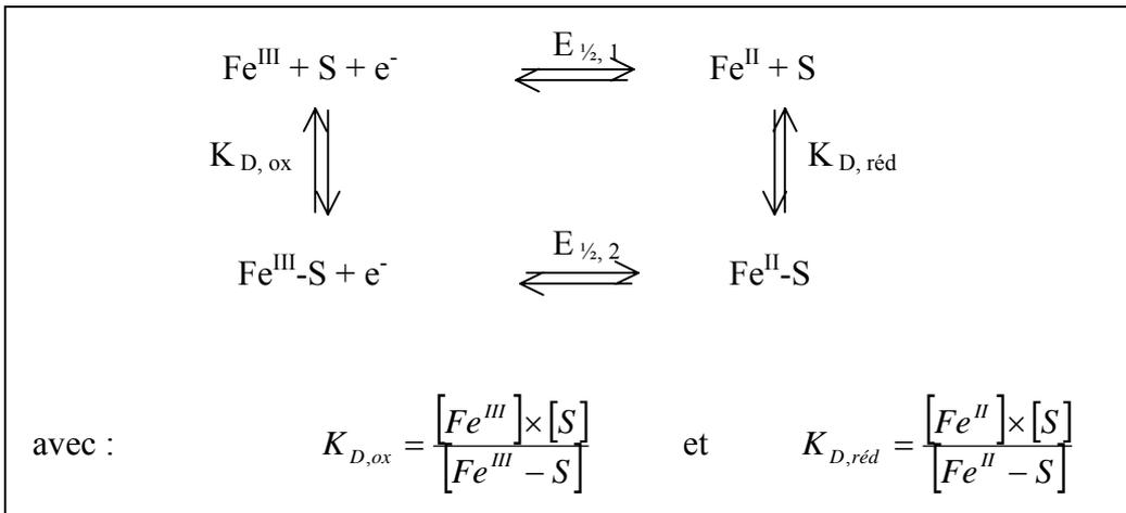
**Figure II.18.** Cycle thermodynamique pour le couple redox Fe<sup>II</sup>/Fe<sup>III</sup> de iNOSoxy en présence d'un substrat S. Dans nos conditions expérimentales, S représente Arg, H<sub>4</sub>B, H<sub>2</sub>B ou encore NO.
