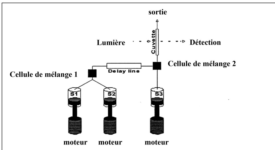
**Figure II.10.** Schéma des circuits et de la chambre interne du système de mélange rapide. Les échantillons sont introduits dans les réservoirs extérieurs avant de pouvoir être stockés dans les seringues (S1, S2 et S3). Le mélange rapide du contenu de chaque seringue est réalisé après injection des échantillons *via* les pistons motorisés, vers la cellule de lecture (« cuvette »). Une chambre interne supplémentaire (« delay line ») permet de réaliser deux réactions en série.
