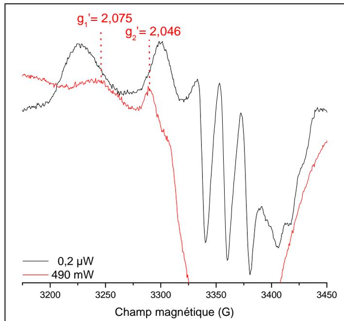
**Figure IV.15.** Superposition des spectres RPE Fe<sup>II</sup>-NO de iNOSoxy +Arg/+H<sub>4</sub>B enregistrés en bande X à 10 K, à 0,2 μW (spectre noir) et 490 mW (spectre rouge).
