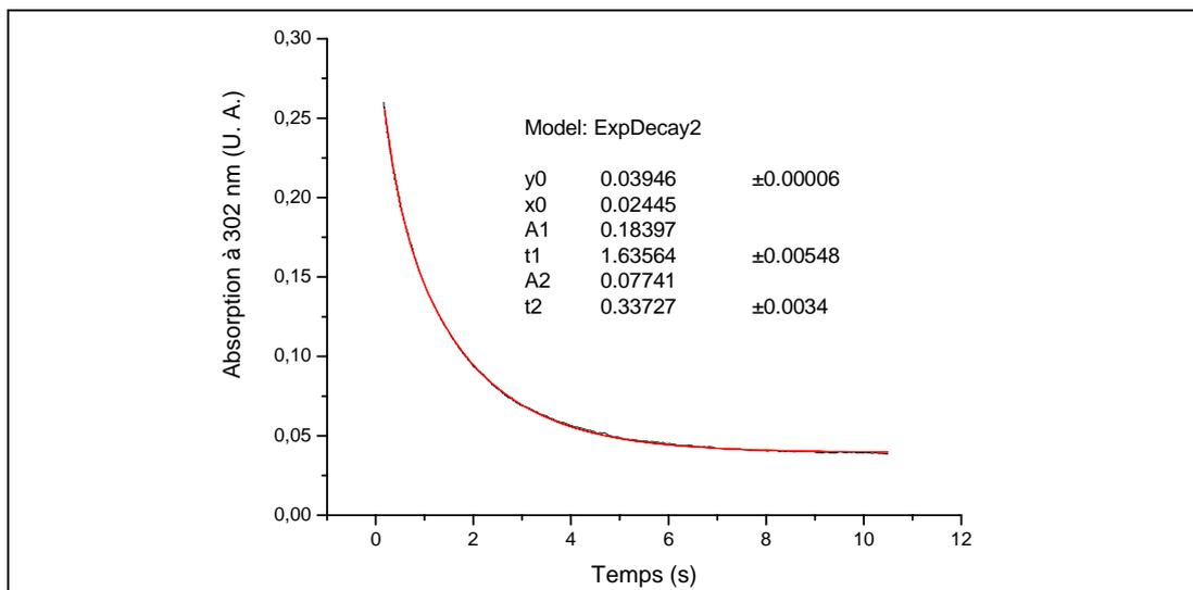
**Figure III.5.** Trace cinétique enregistrée à 302 nm lors de la décomposition de 100  $\mu\text{M}$  PN dans KP<sub>i</sub> 0,1 M plus 0,3 mM DTPA pH 7,4, en présence de 0,1 mM  $\text{CO}_2$  dans le milieu. Modélisation de la cinétique de décomposition du PN par une fonction bi-exponentielle.
