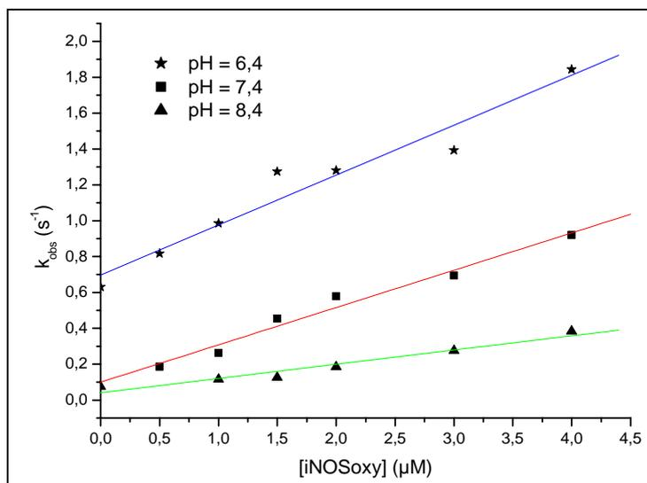
**Figure III.13.** Représentation graphique des constantes de vitesse de décomposition du PN (100  $\mu\text{M}$ ) en fonction de la concentration en iNOSoxy dans KPi 0,1 M ( $-\text{CO}_2$ ) à différentes valeurs de pH : à pH 8,4 (vert), à pH 7,4 (rouge) et à pH 6,4 (bleu).
