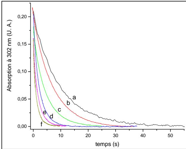
**Figure III.9.** Superposition des traces cinétiques enregistrées à 302 nm pour la décomposition du PN a) dans KPi 0,1 M pH 7,4 (- CO<sub>2</sub>), b) + 0,5 μM iNOSoxy, c) + 1 μM iNOSoxy, d) + 2 μM iNOSoxy, e) + 3 μM iNOSoxy, f) + 4 μM iNOSoxy.
