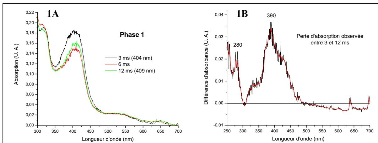
**1.** Première phase de la réaction. A) Superposition des spectres d'absorption enregistrés après 3, 6 et 12 ms de réaction. B) Spectre de différence obtenu par soustraction du spectre enregistré à 12 ms à celui enregistré à 3 ms ; la différence positive d'absorption correspond à l'absorption perdue entre 3 et 12 ms de réaction.
