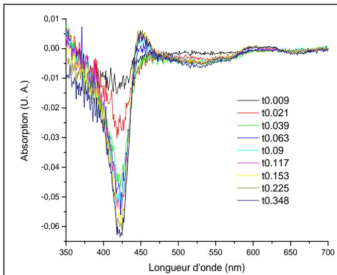
**Figure III.11.** Superposition des spectres de différences calculés pour les 350 premières ms de la réaction de 100  $\mu\text{M}$  PN et 4  $\mu\text{M}$  iNOSoxy dans KPi 0,1 M à pH 7,4 ( $-\text{CO}_2$ ). L'absorption initiale de iNOSoxy à 420 nm diminue au profit de l'apparition d'un intermédiaire (I) qui a un maximum d'absorption autour de 445 nm.
