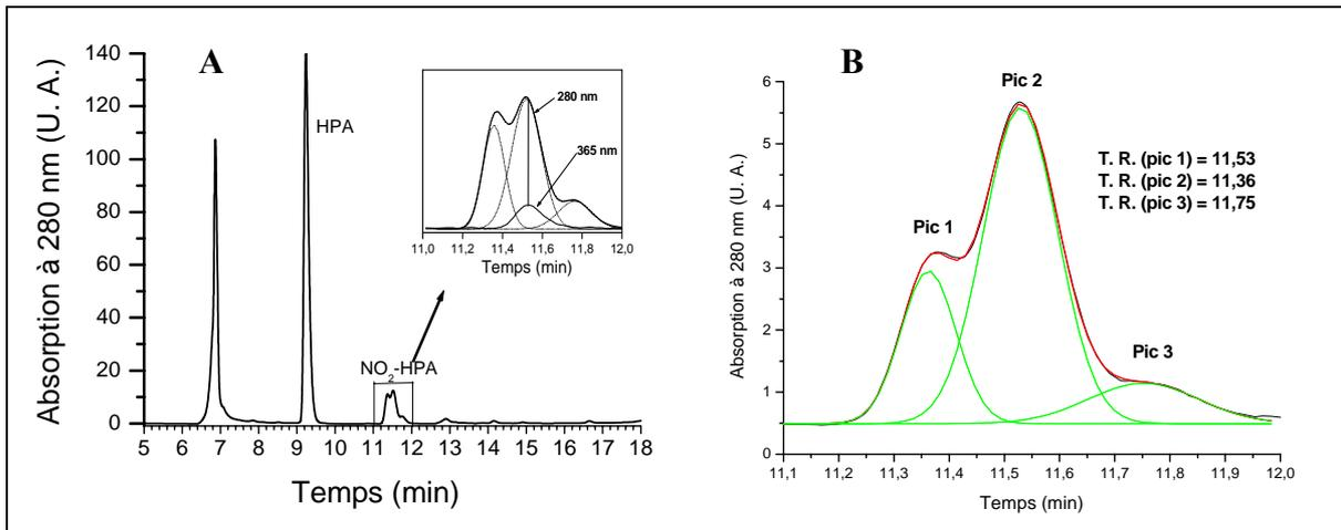
**Figure II.14.** A. Chromatogramme enregistré à 280 nm au cours de l'analyse en HPLC des produits de réaction de HPA avec le peroxy-nitrite. B. Modélisation du massif de pics observés entre les temps de rétention compris entre 11 et 12 min par une fonction somme de 3 gaussiennes. Le pic 2 correspond au nitro-HPA. Il est observé seul sur les chromatogrammes enregistrés à 365 nm.
