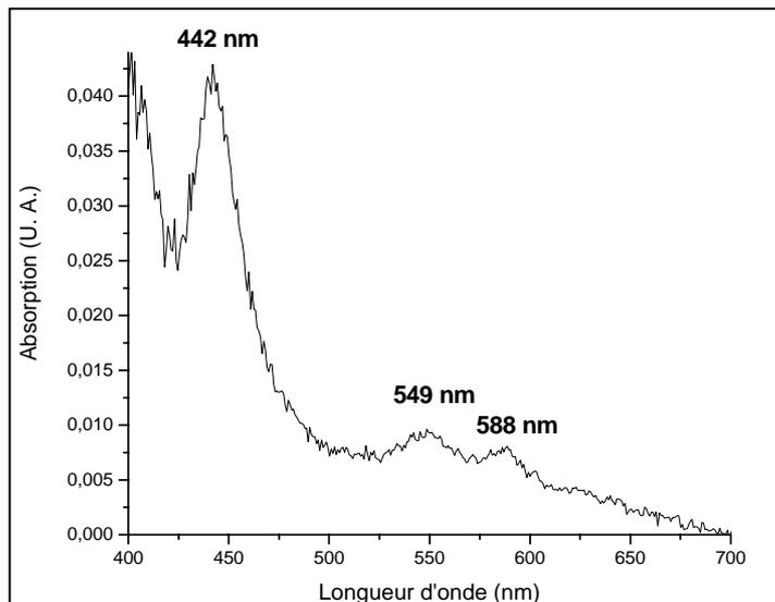
**Figure III.12.** Spectre calculé de l'intermédiaire observé par *stopped-flow* lors de la réaction de 100  $\mu\text{M}$  PN avec 4  $\mu\text{M}$  iNOSoxy dans KPi 0,1 M pH 7,4 en absence de  $\text{CO}_2$ . Au spectre enregistré à  $t = 240$  ms a été soustrait 0,55 x du spectre initial ( $t = 6$  ms).
