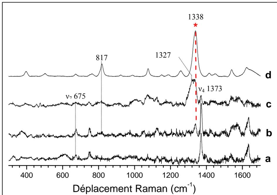
**Figure III.39.** Spectres Raman enregistrés à 457,9 nm, à température ambiante lors de l'analyse de a) iNOSoxy native, b) iNOSoxy plus nitrotyrosine libre en rapport stoechiométrique, c) iNOSoxy modifiée par dix additions de 4 éq. PN, d) nitrotyrosine libre.
