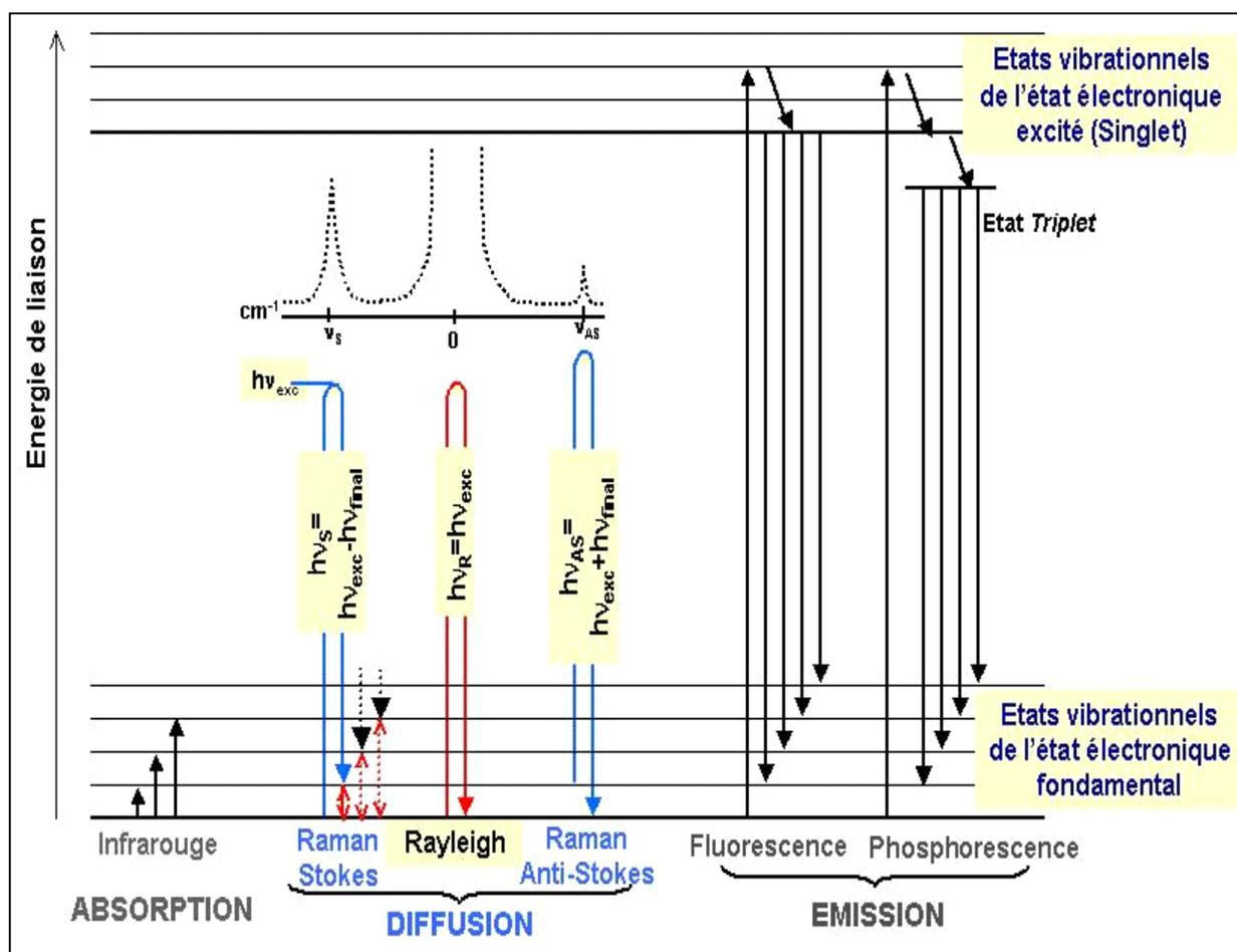
**Figure A.4.** Diagramme de Jablonski présentant les différents processus d'interaction d'une molécule fictive avec la lumière. Les phénomènes de diffusion de la lumière élastique (Rayleigh) et inélastique (Raman, stokes et anti-stokes) sont mis en évidence.
