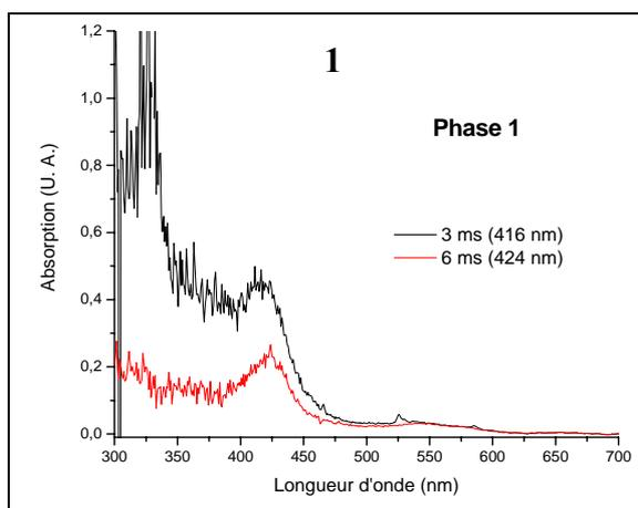
**1. Première phase de la réaction.** Superposition des spectres d'absorption enregistrés après 3 et 6 ms de réaction.
