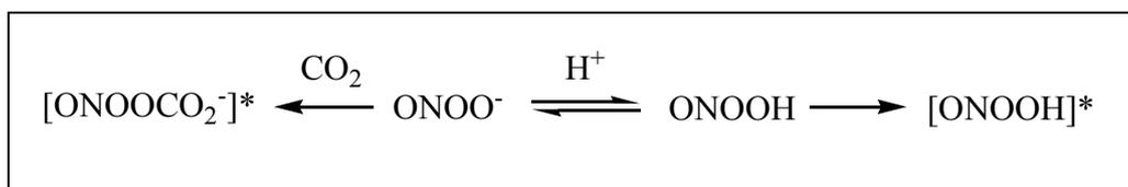
**Figure III.2.** Les deux voies majeures d'activation de la décomposition du PN en solution et en conditions physiologiques : fixation d'un proton (H<sup>+</sup>) ou réaction avec le CO<sub>2</sub> du milieu.
