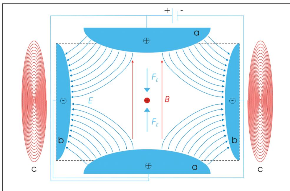
**Figure A.3.** Schéma d'une cellule ICR, ou piège de Penning, contenant une particule de charge positive en son centre (rouge). Le champ électrique  $E$  (bleu) est produit par deux plaques chargées positivement (a) et par une électrode circulaire chargée négativement (b). Le champ magnétique homogène  $B$  (rouge) est produit par un électroaimant toroïdal (c).
