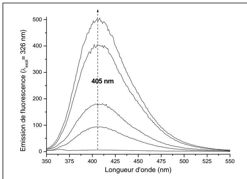
**Figure II.13.** Superposition des spectres de fluorescence enregistrés ( $\lambda_{\text{excitation}} = 326 \text{ nm}$ ) lors de la formation des dimères de HPA par oxydation à 1 électron de HPA par PN. La longueur d'onde d'émission spécifique de di-HPA est à 405 nm.
