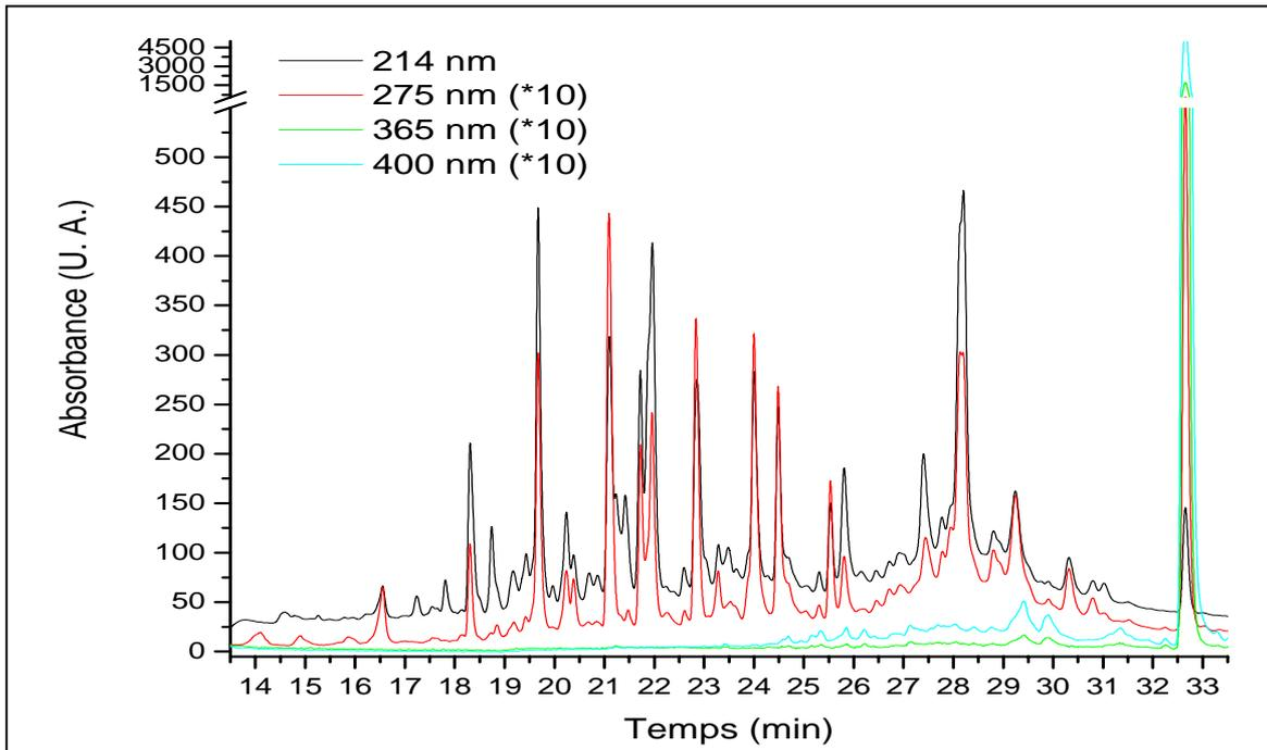
**Figure III.41.** Superposition des chromatogrammes enregistrés à 214 nm (noir), 275 nm (rouge), 365 nm (vert) et 400 nm (bleu) lors de l'analyse en HPLC des fragments obtenus après digestion à la trypsine de iNOSoxy native. Le pic très intense observé à 32,8 min est attribué à la porphyrine. Hormis le chromatogramme enregistré à 214 nm, tous sont multipliés x10.
