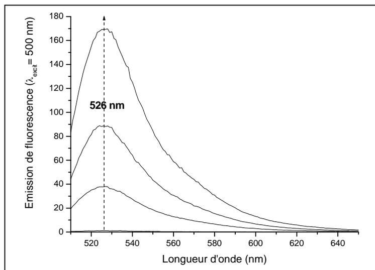
**Figure II.12.** Superposition des spectres de fluorescence enregistrés ( $\lambda_{excitation} = 500 \text{ nm}$ ) lors de la formation de rhodamine par oxydation de DHR par PN. La longueur d'onde d'émission spécifique de la rhodamine est à 526 nm.
