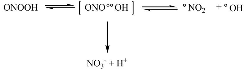
**Figure III.1.** Représentation schématique des deux mécanismes réactionnels proposés pour la décomposition du PN protoné (PNH). **A**) Isomérisation du PNH en acide nitrique par mécanisme de sphère interne. **B**) Rupture homolytique de la liaison O-O formant la paire de radicaux  $\cdot\text{OH}$  et  $\cdot\text{NO}_2$  ; 30 % des radicaux diffuseraient tandis que les 70 % restants recombinaient pour former de l'acide peroxyinitreux et des nitrates.
