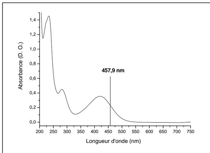
**Figure II.15.** Spectre d'absorption UV-visible de la nitrotyrosine en solution à 50  $\mu\text{M}$  dans KPi 0,1 M pH 7,4.
