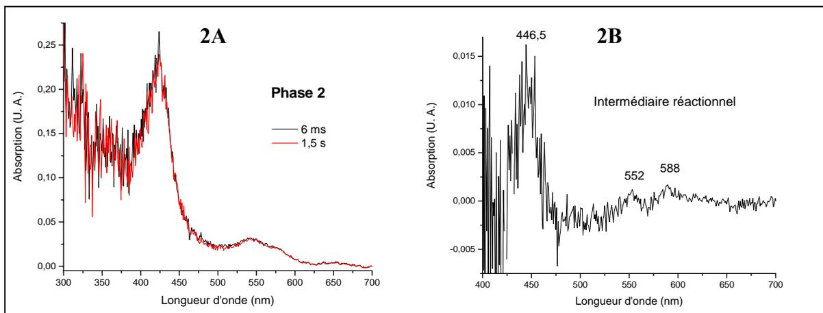
**2. Deuxième phase de la réaction.** A) Superposition des spectres d'absorption enregistrés après 6 ms et 1,5 s de réaction. B) Spectre d'absorption calculé pour l'intermédiaire (I) à  $t = 810$  ms, par soustraction de 90 % du spectre enregistré à 6 ms, le spectre initial étant trop déformé.
