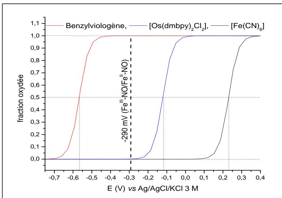
**Figure IV.9.** Courbes d'oxydoréduction des médiateurs utilisés pour la transformation réversible du couple Fe<sup>II</sup>-NO/Fe<sup>III</sup>-NO de iNOSoxy + Arg/+H<sub>4</sub>B à pH 7,4 : le benzylviologène (rouge), le complexe d'osmium [Os<sup>III</sup>(dmbpy)<sub>2</sub>Cl<sub>2</sub>] (bleu), et le ferricyanure (noir). Tous sont inertes au NO. Leurs potentiels redox sont indiqués table IV.3.
