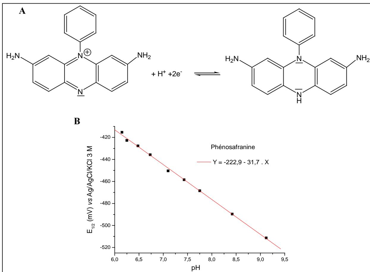
**Figure IV.1.** Présentation du médiateur choisi pour l'étude de l'évolution du potentiel d'oxydoréduction du couple Fe<sup>II</sup>/Fe<sup>III</sup> de iNOSoxy dans différentes conditions d'environnement de l'hème. **A.** Demi-équation redox de la phénosafranine. **B.** Evolution du potentiel d'oxydoréduction  $E_{1/2}$  (mV, vs Ag/AgCl/KCl 3 M) de la phénosafranine, mesuré dans KPi 0,1 M plus 0,1 M KCl, en fonction de la valeur du pH.
