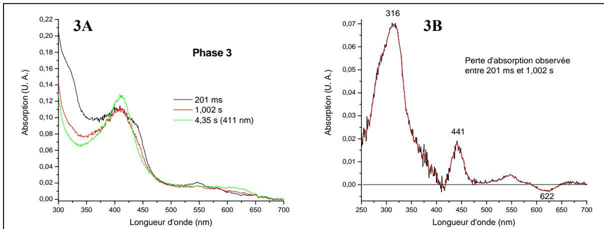
**3. Troisième phase de la réaction.** A) Superposition des spectres d'absorption enregistrés après 0,201, 1,002 et 4,35 s de réaction. B) Spectre de différence obtenu par soustraction du spectre enregistré à 1,002 s à celui enregistré à 0,201 s.
