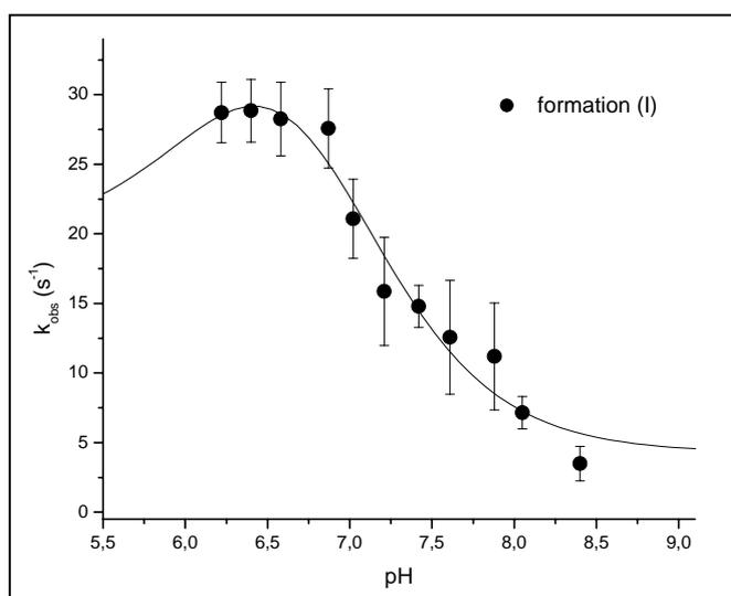
**Figure III.28.** Représentation graphique de l'évolution des constantes de vitesse observées pour la formation de l'intermédiaire à 443 nm, lors de la réaction de 100  $\mu\text{M}$  PN avec iNOSoxy dans KPi 0,1 M pH 7,4 ( $-\text{CO}_2$ ), en fonction de la valeur du pH.
