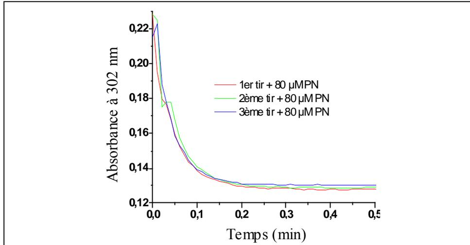
**Figure III.6.** Superposition des traces cinétiques enregistrées en spectroscopie d'absorption UV-visible à 302 nm lors de la décomposition d'additions successives de 80 µM PN dans une même solution KPi 0,1 M pH 7,4 plus 0,2 M DTPA (-CO<sub>2</sub>).
