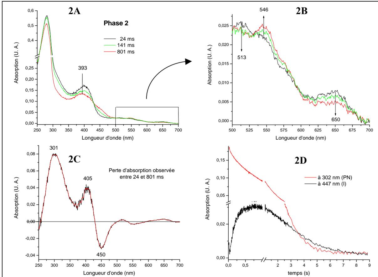
**2. Deuxième phase de la réaction.** A) Superposition des spectres d'absorption enregistrés après 24, 141 et 801 ms de réaction. B) Agrandissement de la zone d'absorption comprise entre 500 et 700 nm de la superposition de spectres de la 2<sup>ème</sup> phase. C) Spectre de différence obtenu par soustraction du spectre enregistré à 801 ms à celui enregistré à 24 ms. D) Superposition des traces cinétiques enregistrées à 302 nm (PN) et à 447 nm (I).
