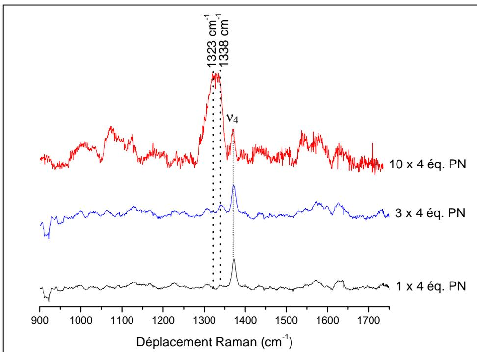
**Figure III.40.** Spectres Raman enregistrés à 457,9 nm, à température ambiante, lors de l'analyse de iNOSoxy modifiée par une (noir), trois (bleu), dix (rouge) additions de 4 éq. PN. Les spectres ont été normalisés sur l'intensité du pic du mode porphyrine  $v_7$  de l'hème à  $675\text{ cm}^{-1}$  pour comparaison.
