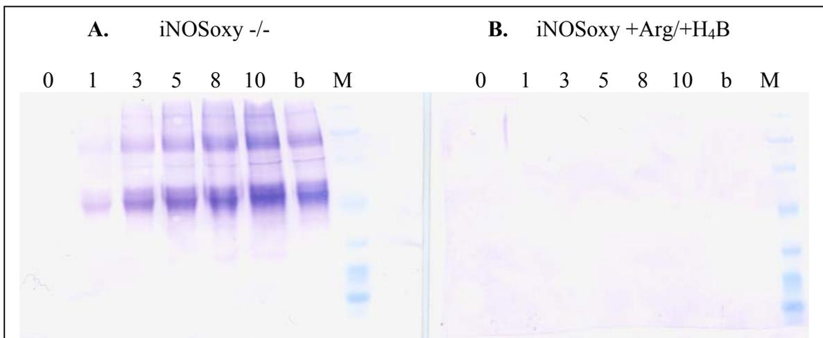
**Figure III.36.** Photo des membranes d'immuno-précipitation révélant la présence de résidus nitrotyrosine sur les échantillons de iNOSoxy -/- modifiée par 0 - 1 - 3 - 5 - 8 - 10 additions de 4 éq. PN dans KPi 0,1 M plus DTPA 0,3 mM pH 7,4 (A). L'échantillon (b) correspond à l'activation de 40 éq. PN par iNOSoxy. Aucun signal n'est détecté sur les échantillons de iNOSoxy +Arg/+H<sub>4</sub>B ayant activé PN dans les mêmes conditions expérimentales (B).
