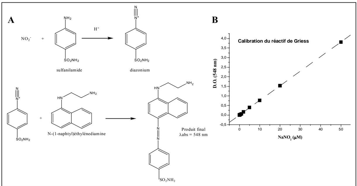
**Figure II.3.** A. Réaction permettant la détection de la production de nitrites (NO<sub>2</sub><sup>-</sup>) grâce au réactif de Griess. Le produit formé absorbe à 548 nm. B. Courbe d'étalonnage du réactif de Griess réalisée par mesure de la densité optique à 548 nm après réaction avec des échantillons de nitrite de sodium commercial en solution (Y = 0,00157 + 0,07632 X).
