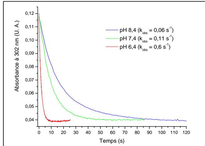
**Figure III.4.** Décomposition de 100 µM PN dans KPi 0,1 M -CO<sub>2</sub> à différentes valeurs de pH: pH 8,4 (bleu), pH 7,4 (vert), pH 6,4 (rouge).
