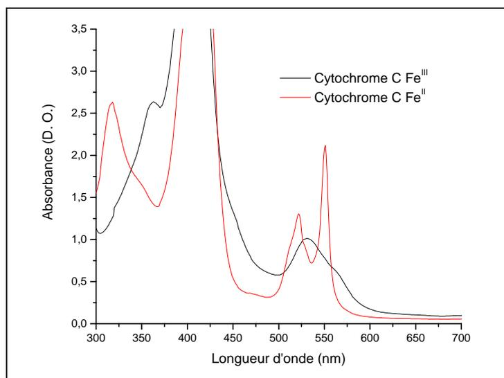
**Figure II.7.** Superposition des spectres d'absorption UV-visible du cytochrome c avant (Fe<sup>III</sup>) et après réaction avec le dithionite (Fe<sup>II</sup>) dans un tampon HEPES 0,1 M pH 7,4.
