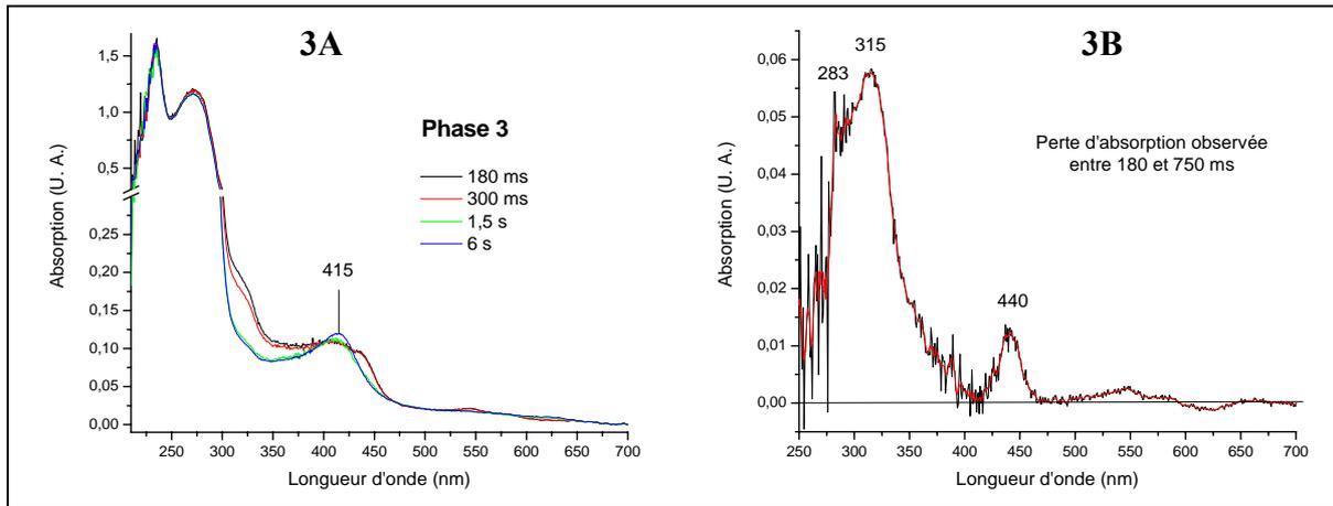
**3. Troisième phase de la réaction.** A) Superposition des spectres d'absorption enregistrés après 0,18, 0,3, 1,5 et 6 s de réaction. B) Spectre de différence obtenu par soustraction du spectre enregistré à 750 ms à celui enregistré à 180 ms.
