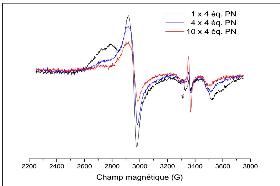
**Figure III.45.** Spectres RPE enregistrés à 15 K sur des échantillons de iNOSoxy modifiée par une (noir), quatre (bleu), dix (rouge) additions de 4 éq. PN. Tous les échantillons sont conditionnés dans HEPES 0,1 M pH 7,4 pour l'analyse RPE. Seul le signal de l'espèce BS est présent. Le signal d'un radical a été observé sur le spectre RPE de l'échantillon de iNOSoxy modifié par 1 x 4 éq. PN (\*); il doit s'agir d'un contaminant puisqu'il n'a pas été observé lorsque l'expérience a été reproduite.
