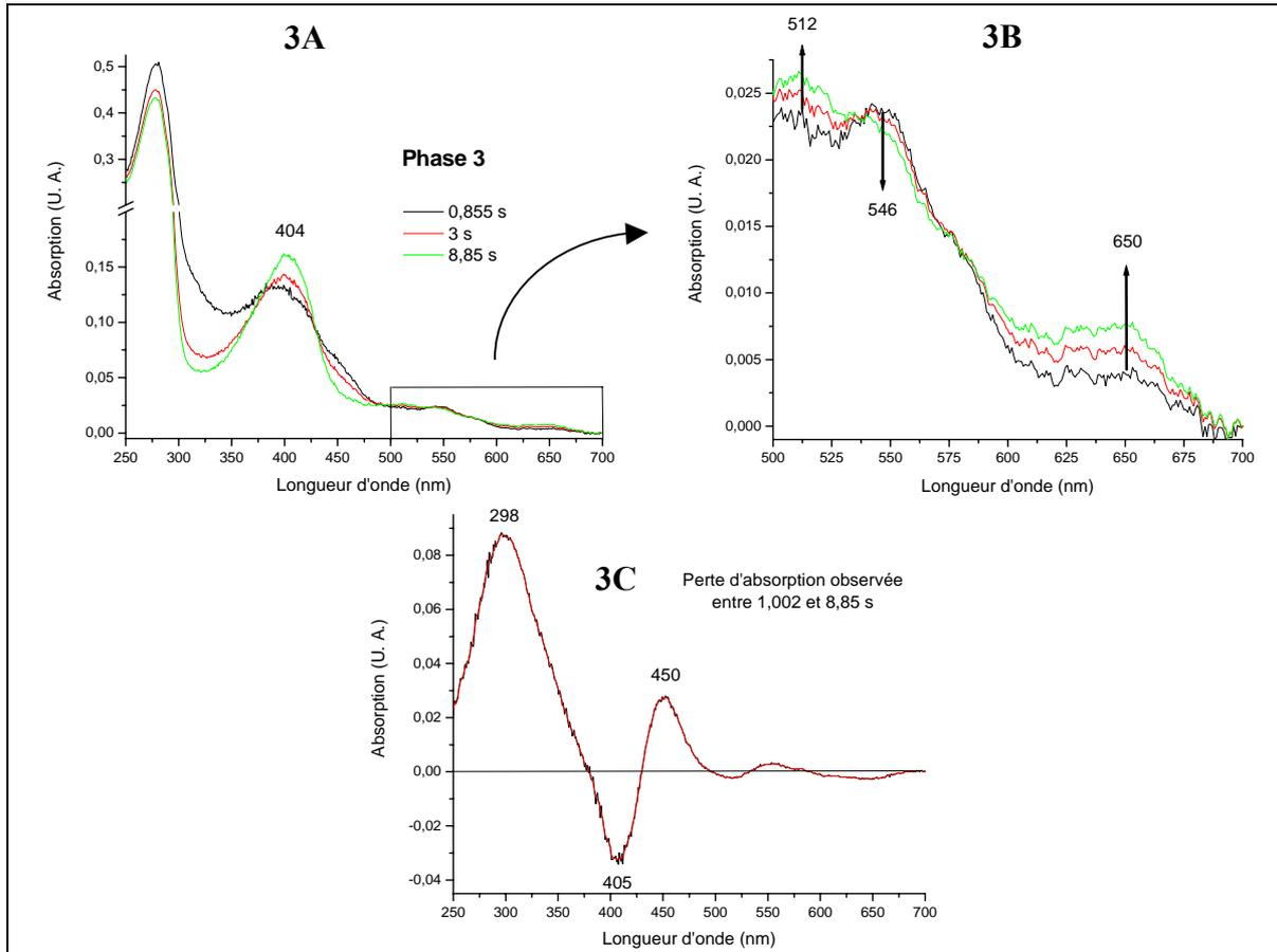
**3. Troisième phase de la réaction.** A) Superposition des spectres d'absorption enregistrés après 0,855, 3 et 8,85 s de réaction. B) Agrandissement de la zone d'absorption comprise entre 500 et 700 nm de la superposition de spectres de la 3<sup>ème</sup> phase. C) Spectre de différence obtenu par soustraction du spectre enregistré à 8,85 s à celui enregistré à 1,002 ms.
