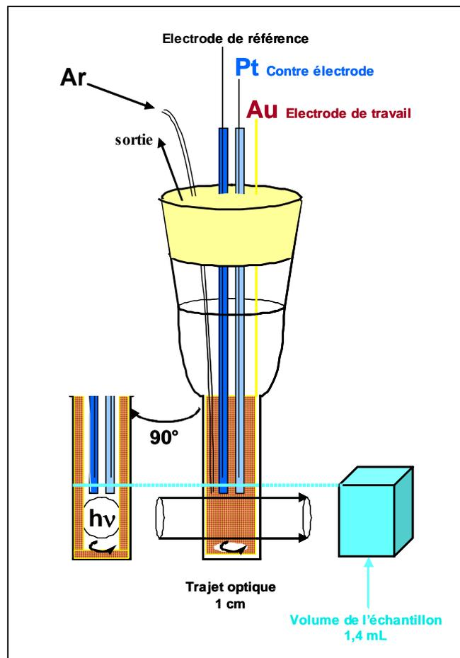
**Figure II.16.** Schéma représentant la cellule de spectroélectrochimie utilisée.
