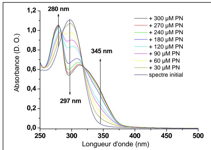
**Figure II.11.** Suivi par spectroscopie d'absorption UV-visible de la réaction du PN sur  $H_4B$  dans une solution de NaOH pH 12. Est mise en évidence la disparition de l'absorption de  $H_4B$  (297 nm) au profit de l'apparition de deux nouvelles absorptions à 280 nm et à 345 nm.
