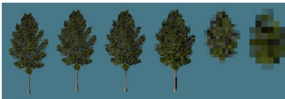
FIG. 3-29 – Représentation en niveaux de détails d’un arbre [Weber and Penn, 1995]. Les éléments composants cet arbre sont d’abord représentés par des polygones (à gauche). Puis, pour les vues les plus éloignées, les branches sont représentées par des lignes avec plus ou moins de segments et les feuilles par des points (à droite).
