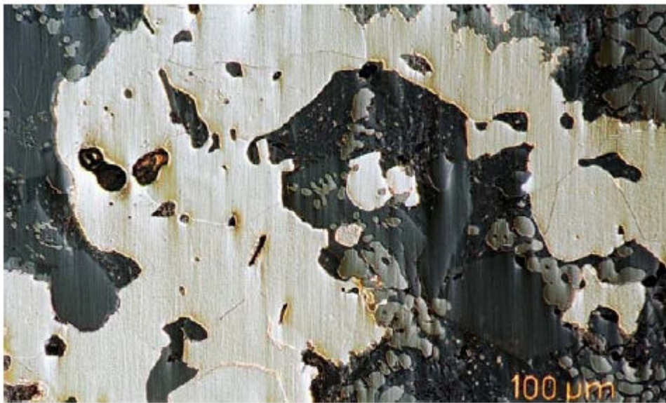
Figure 13: Filament métallique après attaque nital MO (GL04-07).
