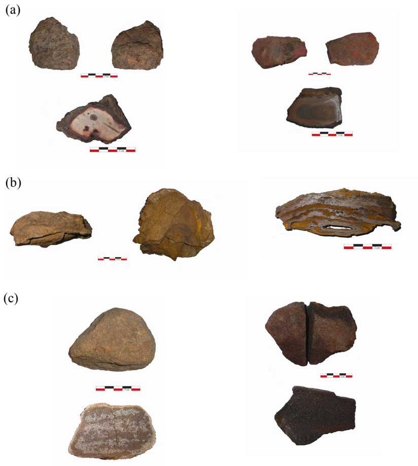
Figure 35 : Morphologie des minerais mis au jour sur le site du Près de Montadet : (a) Type I, (b) Type II, (c) Type III.
