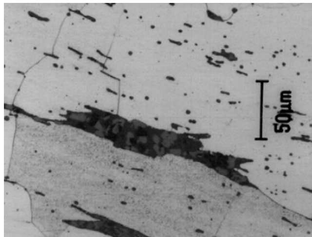
Figure 9 : Inclusions contenant des dendrites de wüstite dans une matrice fayalitique [23].
