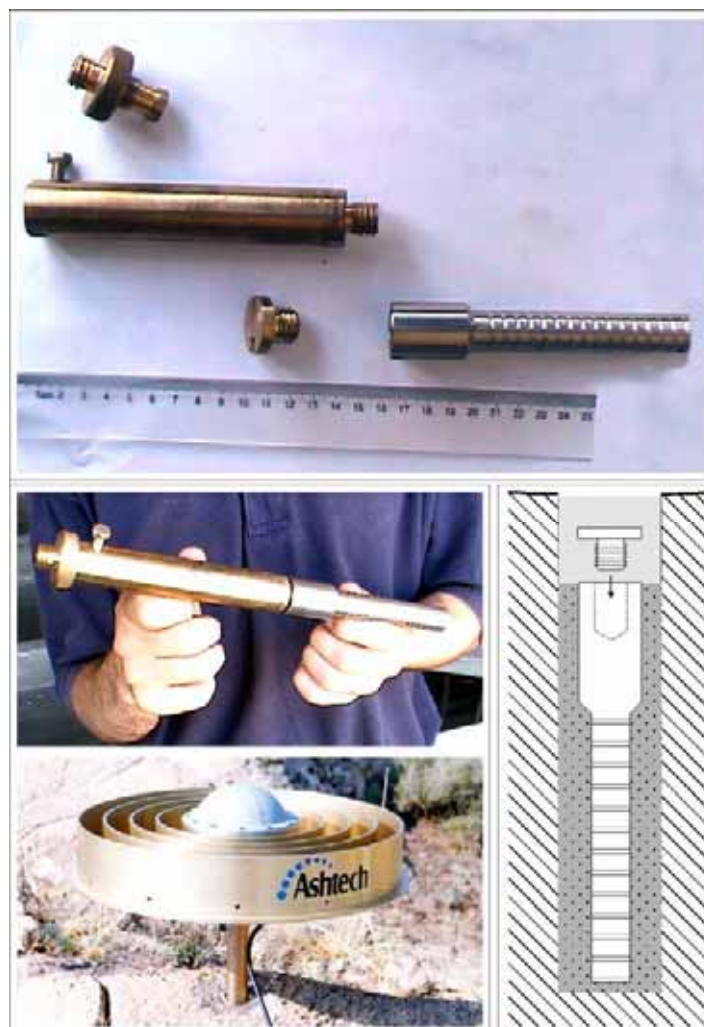
Figure II - 9 : Le standard de repère installé en Arménie en 2003.
