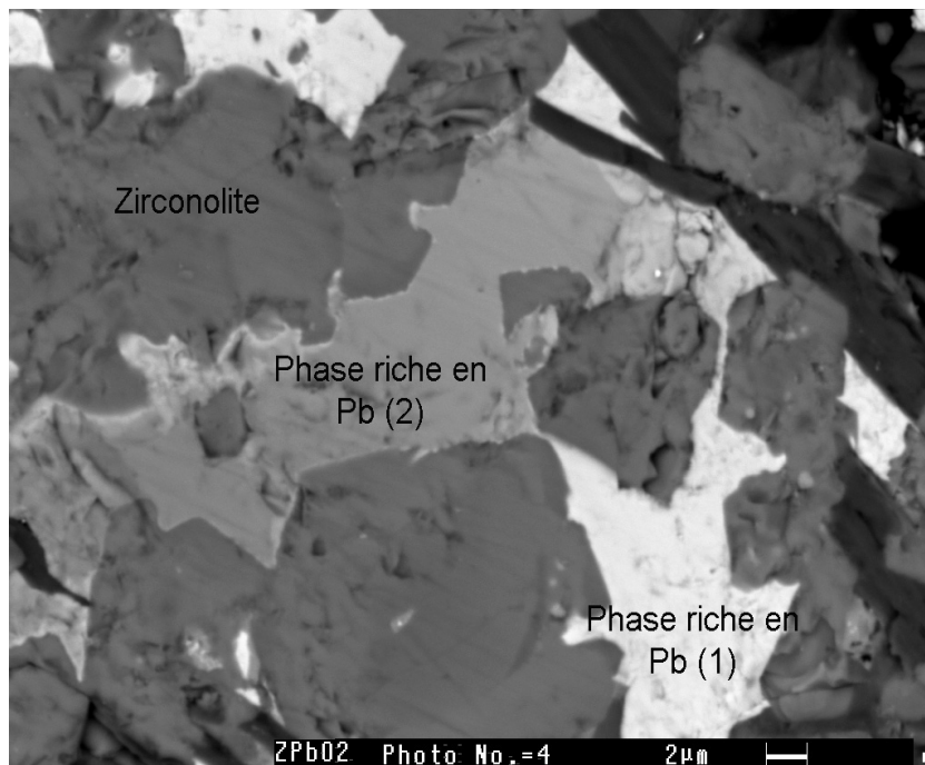
FIGURE 7.5 – Image MEB en électrons rétrodiffusés de AZPb2 centrée sur les nouvelles phases riches en plomb
