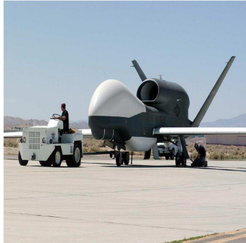
(a) Drone militaire de surveillance Global Hawk (Northrop Grumman, 1000 kg de charge utile, 30 mètres d'envergure)
