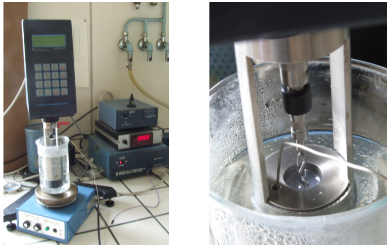
FIG. II.13 - Montage expérimental de mesure de viscosité
