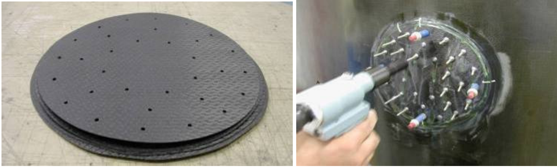
FIG. 1.29 - Solution hybride de patch riveté/collé d'Eurocopter [Brunel, 2007]
