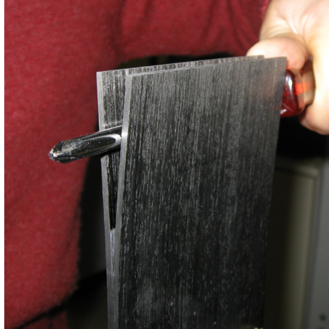
FIG. III.3 – Ouverture d'une plaque stratifiée ( [0_1\delta] ) afin de réaliser une réparation par collage pour les essais de mécanique de la rupture
