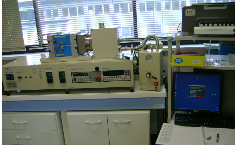
Figure 19 : Dispositif ZEM-3 de la société ULVAC-RIKO
