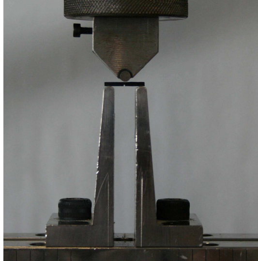
Figure 6 : Chargement en flexion 3 points d'une éprouvette \text{Ca}_3\text{Co}_4\text{O}_9 entaillée.
