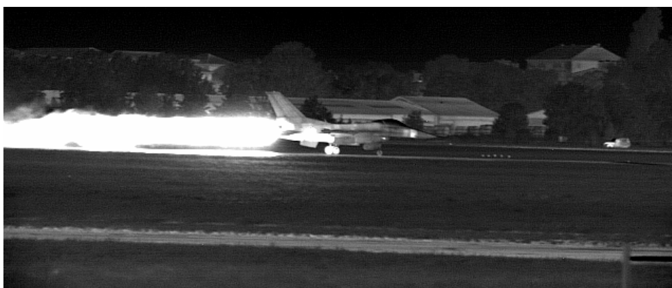
Figure 1.9 : Image QWIP à 8,5 \mu\text{m} présentant l'évolution du contraste de l'image IR avec l'émissivité.
