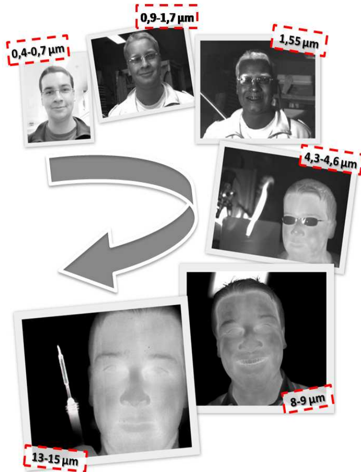
Figure 1.10 : Évolution du contraste de l'image avec la longueur d'onde.
