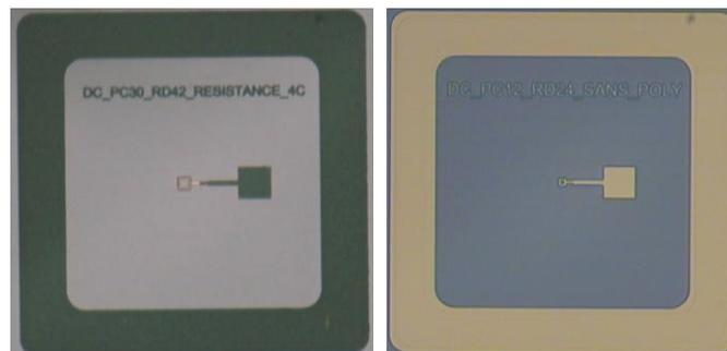
**Figure 4-5 : deux photodiodes de 12µm et 30µm de côté, avec et sans résistance.**
