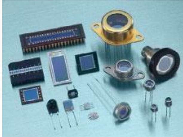
**Figure 1-10 : des échantillons de photodétecteurs Hamamatsu (APD-Geiger, SiPM, ...).**
