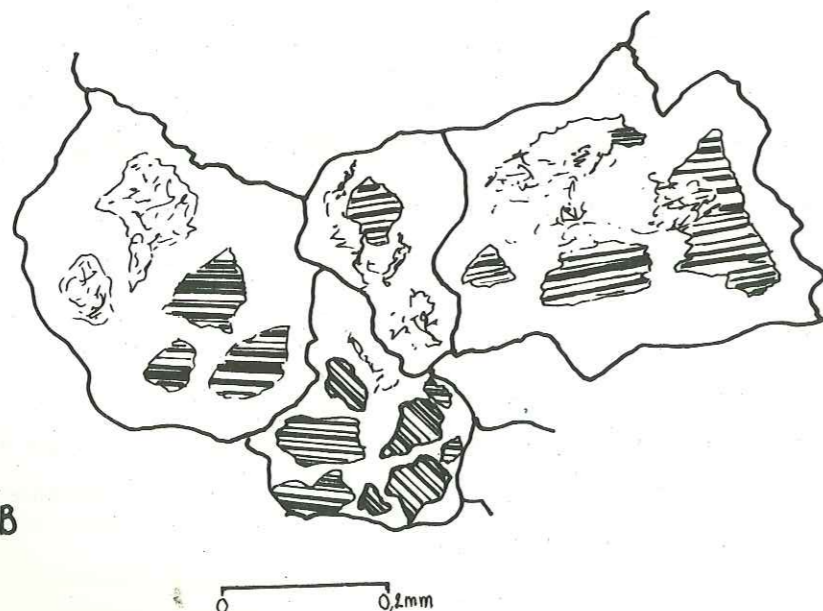
Figure 80 : Inclusions de plagioclase montrant deux familles d'orientation différente de leurs macles dans un autre plagioclase.
