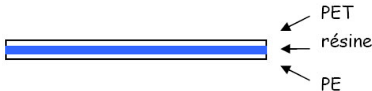
FIGURE A.1 – La résine en film SY300 est protégée par deux films plastiques. L’un est en PE et l’autre en PET. L’épaisseur de la résine (en bleue) définit la hauteur des objets que l’on peut créer sur la surface, et donc dans notre cas la hauteur du canal. Plusieurs couches peuvent être utilisées pour atteindre l’épaisseur souhaitée. Il existe des résines de 20, 30 et 50\ \mu\text{m} d’épaisseur.
