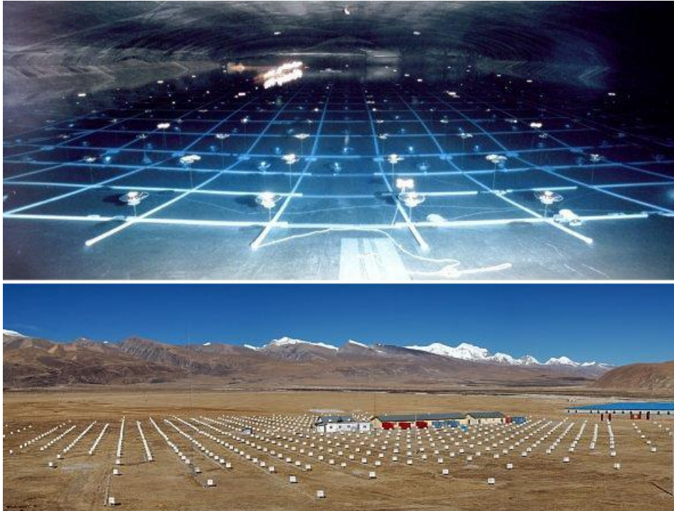
FIG. III.7 – Haut : l'expérience Milagro Gamma-Ray Observatory (Abdo et al., 2009 Milagro) est situé près de Los Alamos (Nouveau Mexique, Etats-Unis) et est constitué un immense réservoir d'eau. Bas : le détecteur Tibet-III Air Shower Array (Amenomori et al. 2010), situé près de Lhassa (Tibet), est constitué de plusieurs centaines de scintillateurs plastiques.
